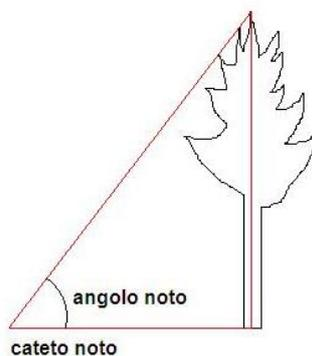
Figura 4.7 – Principio trigonometrico alla base dell'ipsometro
