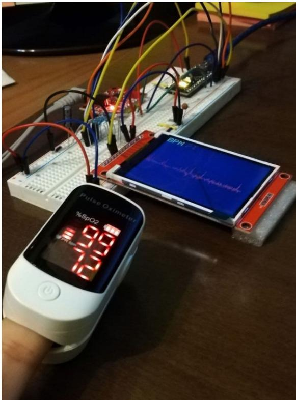
Fig. 15 - Confronto prototipo e saturimetro
