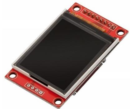
Per questo progetto è stata fatta una prima prova con un display da 1,8 pollici per successivamente sfruttare un display più grande da 2.8" per agevolare la visione nel prototipo.
