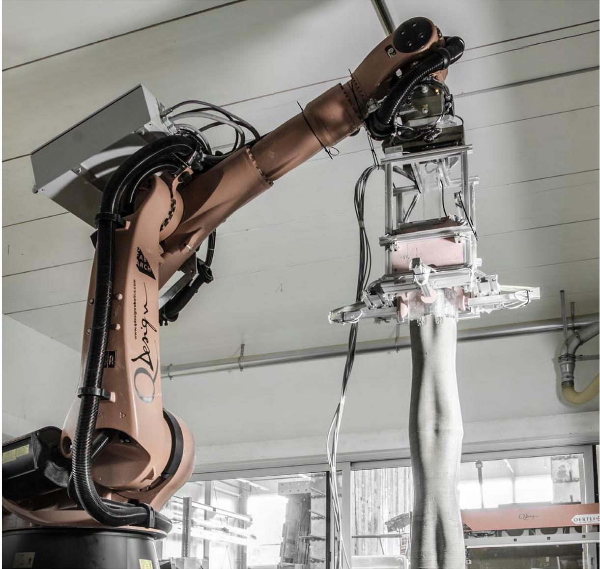
Figura 6.5: Tecnica di formatura *Smart Dynamic Casting* sviluppata presso l'ETH di Zurigo, Svizzera. La dott.ssa Ena Lloret-Fritschi dell'Università svizzera ha guidato una ricerca interdisciplinare sviluppando una nuova tecnica di formatura dinamica a scorrimento che, tramite controllo robotico della velocità, permette al materiale di generare strutture con geometria complessa che variano la rigidità. Da Simondetti A. *et al.*, 2020. *Designing with Digital Fabrication*, ARUP, Londra, p. 42.
