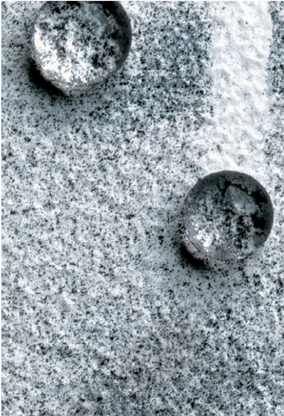
Figura 5.2: Funzionamento della vernice da rivestimento esterno super idrorepellente con tecnologia Lotus-Effect® della Sto Corp. Da Sto Corp, 2019, Coatings. [online] *Sto Corp*. Disponibile su: <[www.stocorp.com/coatings-us/](http://www.stocorp.com/coatings-us/)> [Data di accesso: 8 marzo 2021].
