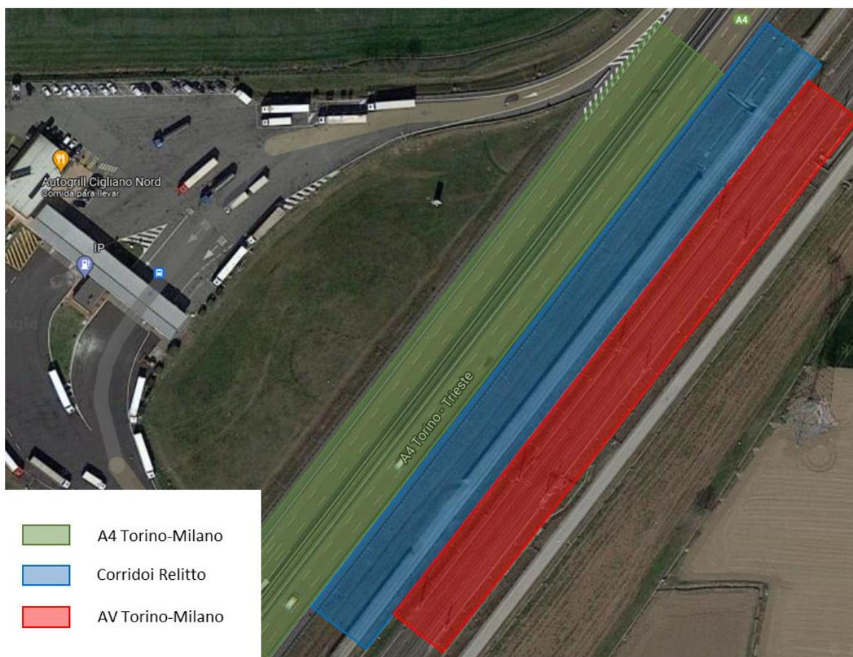
**Figura 2.53:** Immagine da satellite sulla conformazione della divisione di infrastrutture parallele all'autostrada A4 Torino – Milano , Fonte: Google maps
