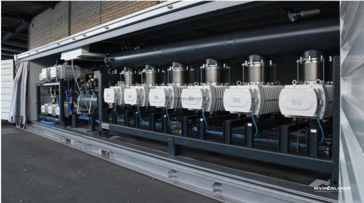
**Figura 2.16:** Pompe a vuoto e alloggiamento modulare, per gentile concessione di HyperloopTT. Il sistema HyperloopTT è progettato per avere un'energia netta positiva nel corso di un anno.
