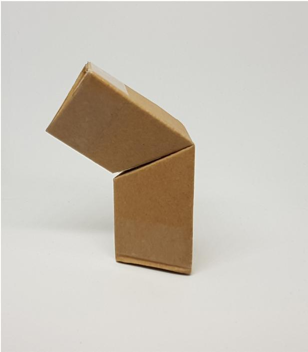
fig. 48: Prova di piega ad angolo ottuso
