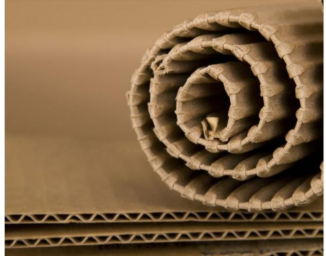
fig. 41: Cartone ad una sola onda
