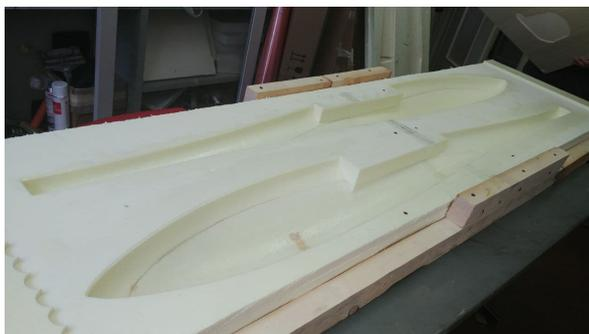
**Figure 3.7:** Fotografia dello stampo per la Fusoliera
