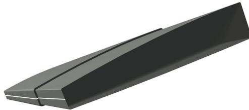
**Figure 4.13:** Geometria del modello FEM del cassone alare
