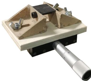
**Figure 5.12:** Morsa per l'afferraggio delle piastrine
