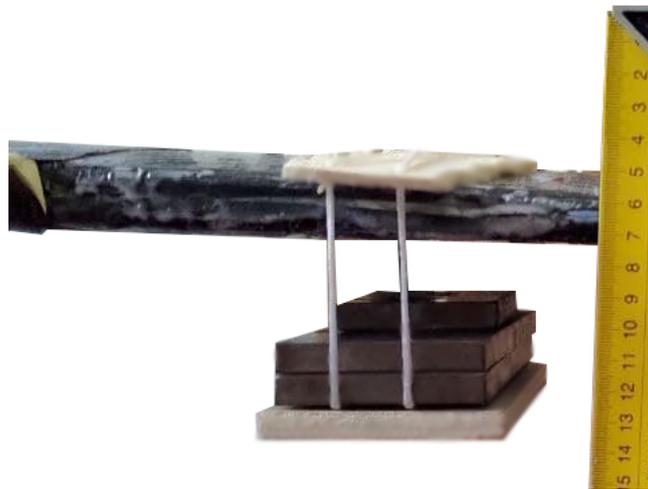
**Figure 4.18:** Setup per la misurazione della freccia e per la applicazione del carico
