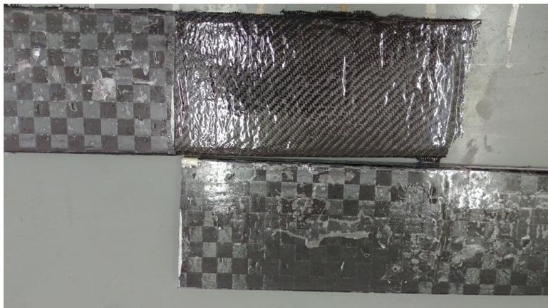
**Figure 3.4:** Fotografia della giunzione della semiala sinistra
