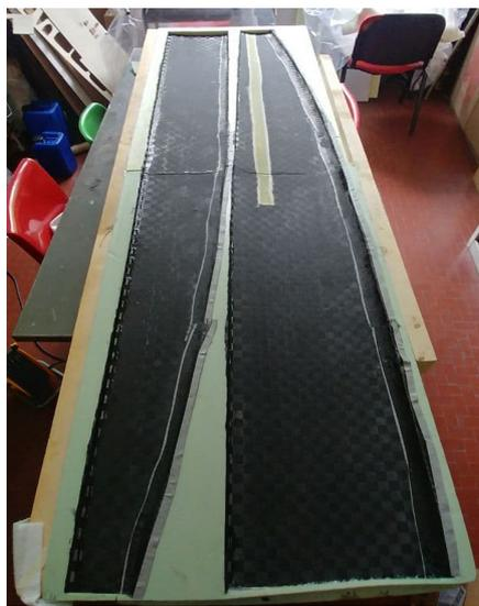
**Figure 3.5:** Fotografia del guscio dopo essere stato laminato
