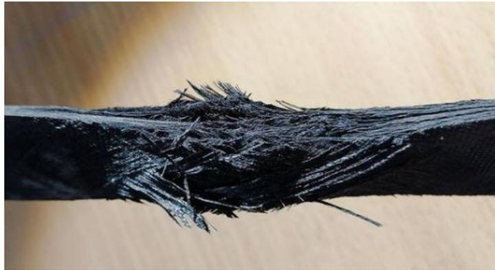
**Figure 4.10:** Modo di rottura provino con laminazione  $\pm 45$
