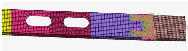
**Figure 4.16:** Modellazione dei fori di alleggerimento sul ventre nell'ambiente FEM
