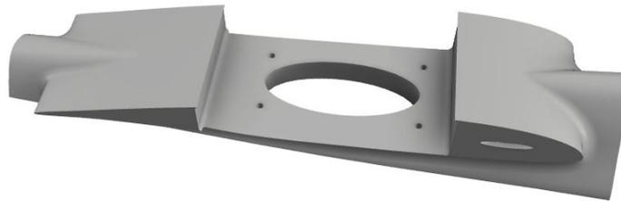
**Figure 2.6:** Rappresentazione della giunzione alare
