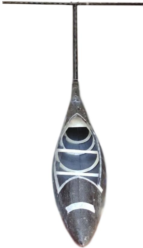
**Figure 3.8:** Fusoliera durante l'incollaggio di chiusura
