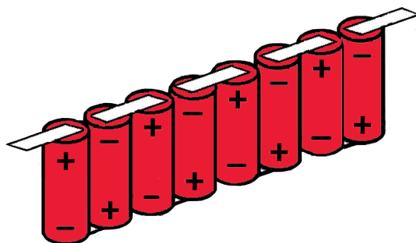
Figura 3.2: Schematizzazione collegamento in serie
