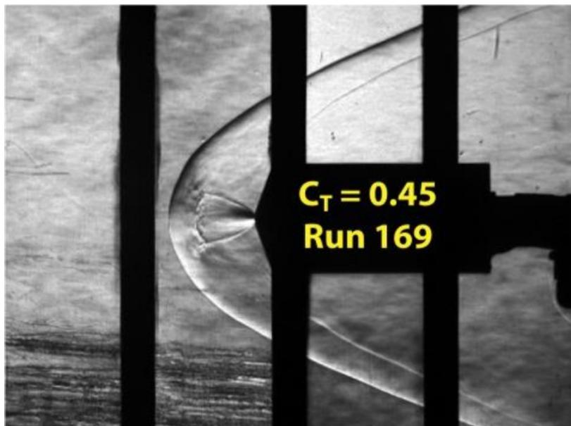
Figura 7-36 Schlieren runcase 169 ottenuta sperimentalmente
