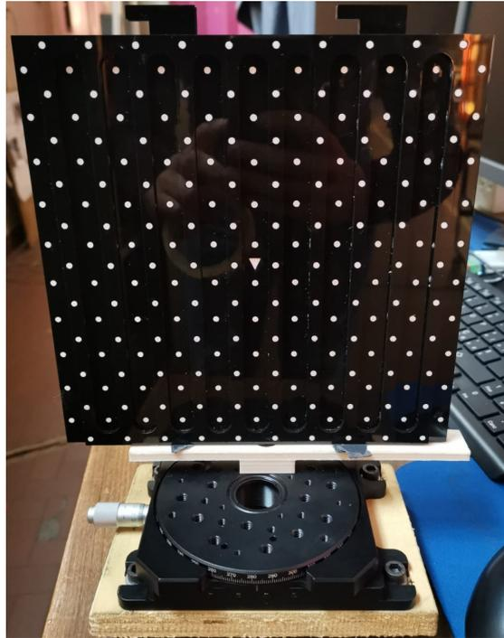
**Figura 2.10:** Il target di calibrazione.
