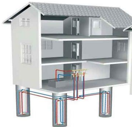
Figura 22: Schema rappresentativo dei pali energetici
