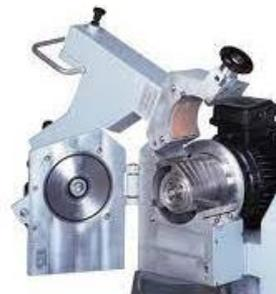
**Figura 3.10** – Mulino Retsch SM 2000 utilizzato per la comminazione.
