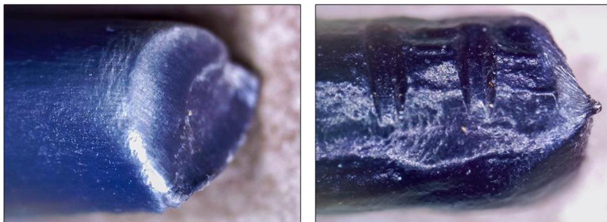
**Figura 4.36** – Foto al microscopio del filamento di PP RAEE HIGH ADD (a sinistra) e LOW ADD (a destra)
