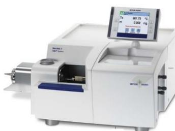
**Figura 3.5** – Termobilancia TG/DSC METTLER-TOLEDO.
