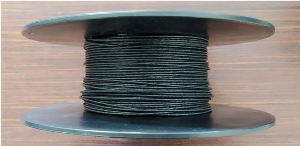
**Figura 4.32** – Bobina del filamento di PP RAEE LOW ADD ottenuto con i parametri del test 3.
