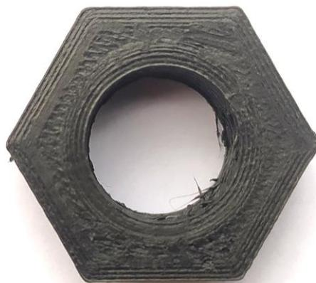
*Figura 4.40 – Problema dello stringing all'interno delle parti vuote del provino stampato.*
