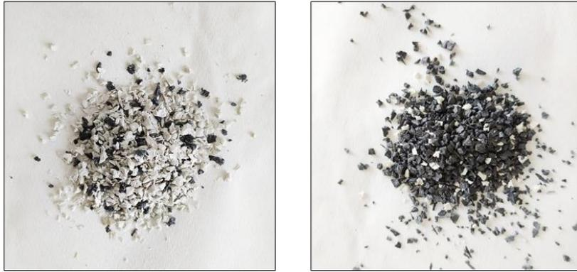
**Figura 4.22** – Campione con granulometria < 4 mm di PP RAEE HIGH ADD (a sinistra) e LOW ADD (a destra).
