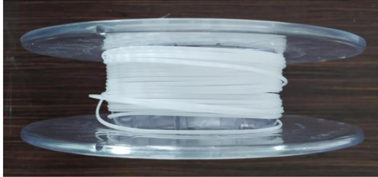
**Figura 4.15** – Bobina del filamento di PP INEOS 500GA-20 ottenuto con i parametri del test 4.
