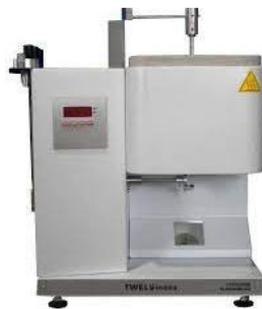
*Figura 3.7 – Twelv index usato per determinare l'MFI.*
