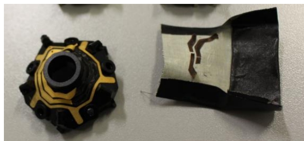
Figura 58: immagine del campione in PC/ABS testato con peeling manuale a seguito dell'analisi di thermal humidity. Si nota come il coating metallico si stacca interamente dal substrato polimerico.
