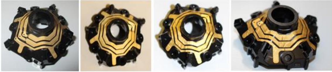
Figura 51: immagine rappresentativa del campione in PC/ABS dopo (a partire da sinistra) 250, 500, 750 e 1000 ore nelle condizioni di prova.
