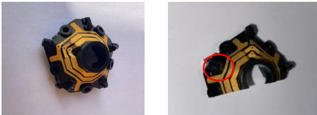
Figura 26: immagine del campione in PC/ABS processato attraverso tecnica SSAIL per la generazione di tracce conduttive (a sinistra) e immagine che evidenzia zone over-plated (a destra).
