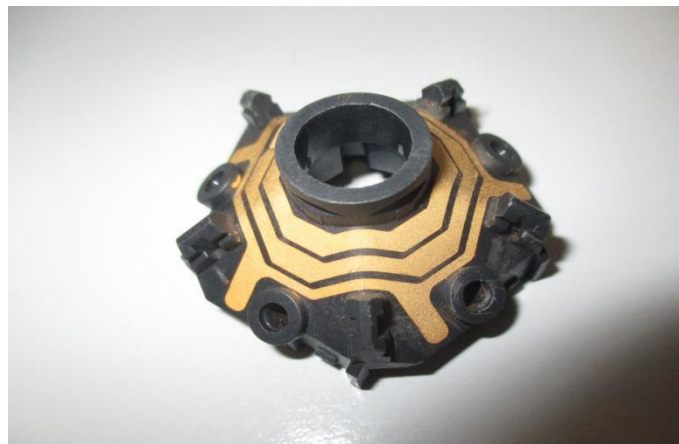
Figura 52: immagine rappresentativa del campione in PA6 dopo 750 ore a 125°C.
