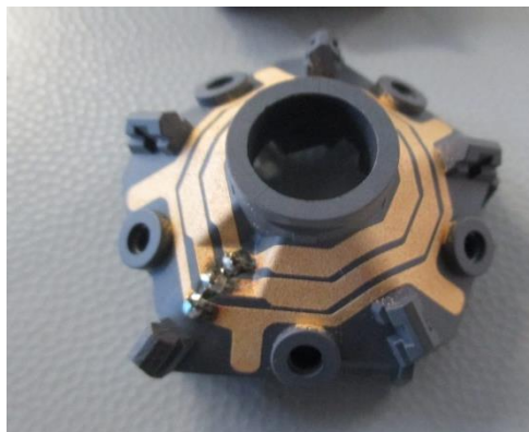
Figura 56: immagine del campione di riferimento in PA4T additivato a seguito dell'analisi di thermal humidity dopo 1000 ore nelle condizioni di lavoro.
