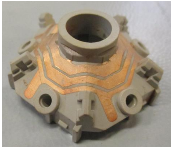
Figura 57: immagine del campione in ABS a seguito dell'analisi di thermal humidity dopo sole 250 ore nelle condizioni di lavoro. Si notano leggeri distacchi del coating metallico.
