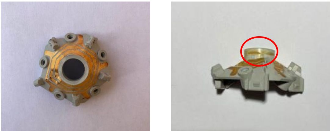
Figura 25: immagine del campione in ABS processato attraverso tecnica SSAIL per la generazione di tracce conduttive (a sinistra). A destra si mostrano le evidenti sbavature metalliche generate durante la metallizzazione.
