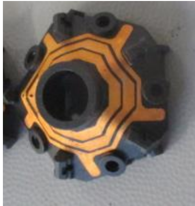
Figura 59: immagine del campione in PA6 a seguito dell'analisi di thermal humidity dopo 500 ore nelle condizioni di lavoro.
