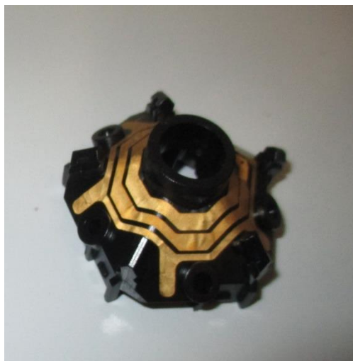
Figura 50: immagine rappresentativa del campione in PC/ABS dopo 250 ore a 125°C dimostrante la presenza di piccoli segni di delaminazione.
