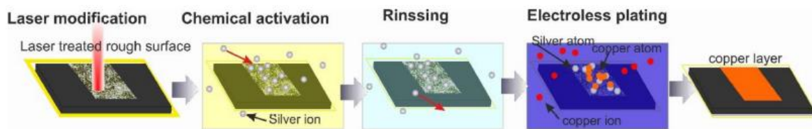
Figura 14: rappresentazione schematica degli step che compongono il processo SSAIL. Figura tratta da [18].
