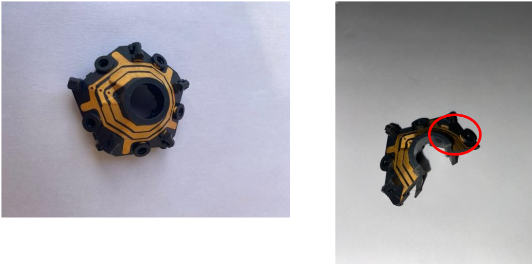
Figura 24: immagine del campione in PA6 processato attraverso tecnica SSAIL per la generazione di tracce conduttive (a sinistra) e immagine dei particolari over-plated (a destra).
