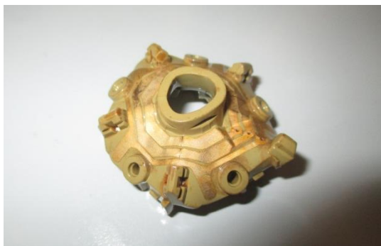
Figura 49: immagine del campione in ABS dopo 250 ore a 125°C. La resina presenta una colorazione giallastra segno di una degradazione termica importante.
