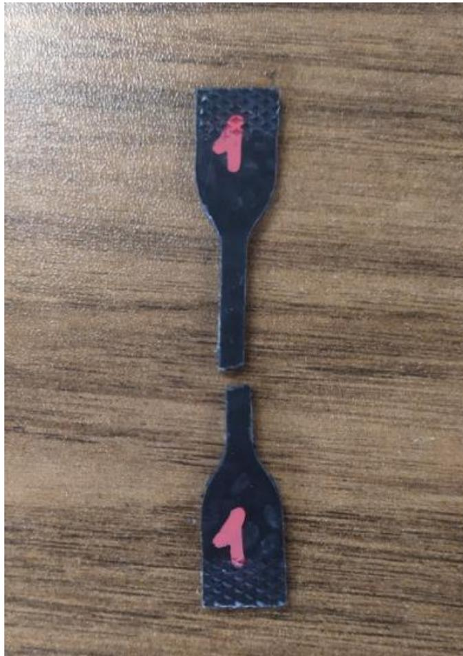
**Figura 4.18:** provino ad osso di cane piatto utilizzato per le prove di trazione.
