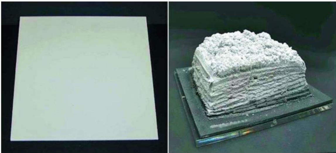
**Figura 3.9:** strato di char ottenuto grazie agli IFR da un provino di un millimetro di spessore. A sinistra il materiale pre-combustione e a destra post-combustione [15].
