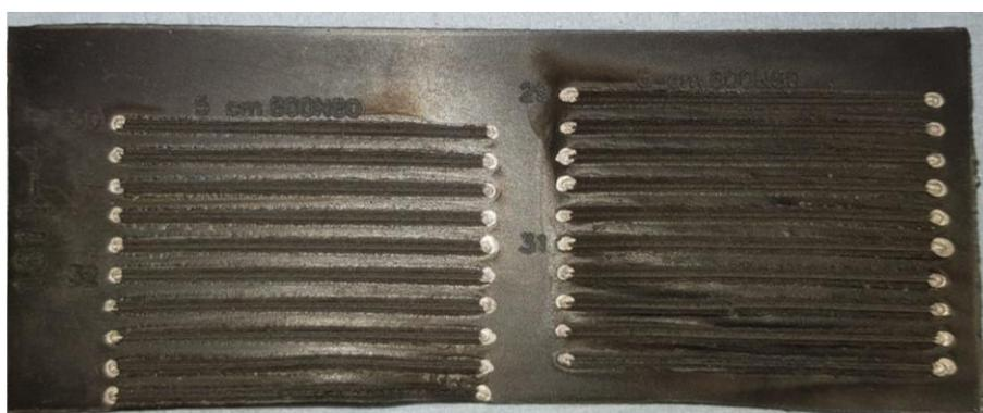
**Figura 5.29:** tracce laser di lunghezza pari a 5 cm.
