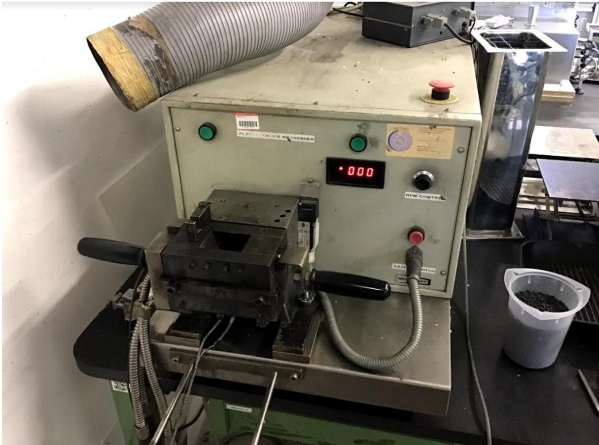
**Figura 4.12:** miscelatore Brabender utilizzato per incorporare il grafene nella matrice di PP precedentemente caricato con il vetro.
