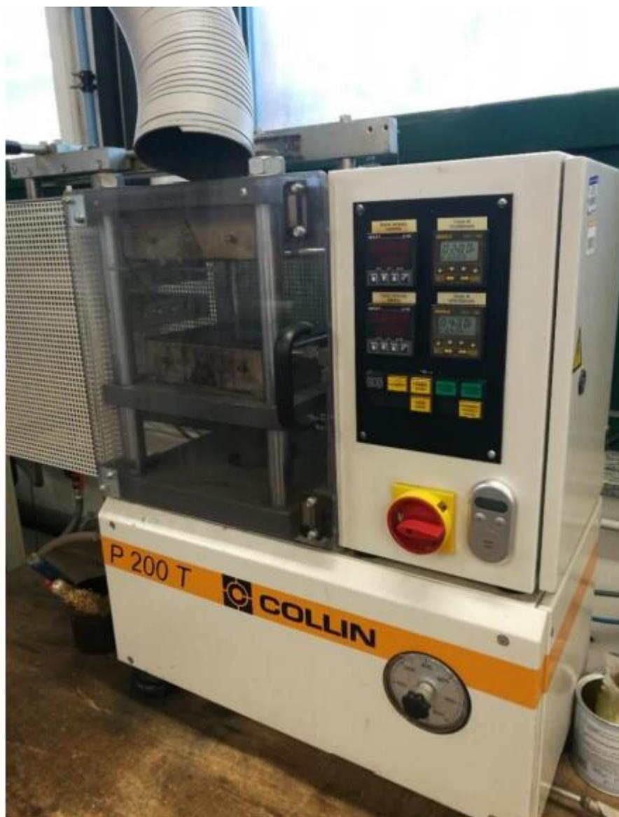
**Figura 4.14:** Pressa Collin P 200 T utilizzata per la produzione dei provini.
