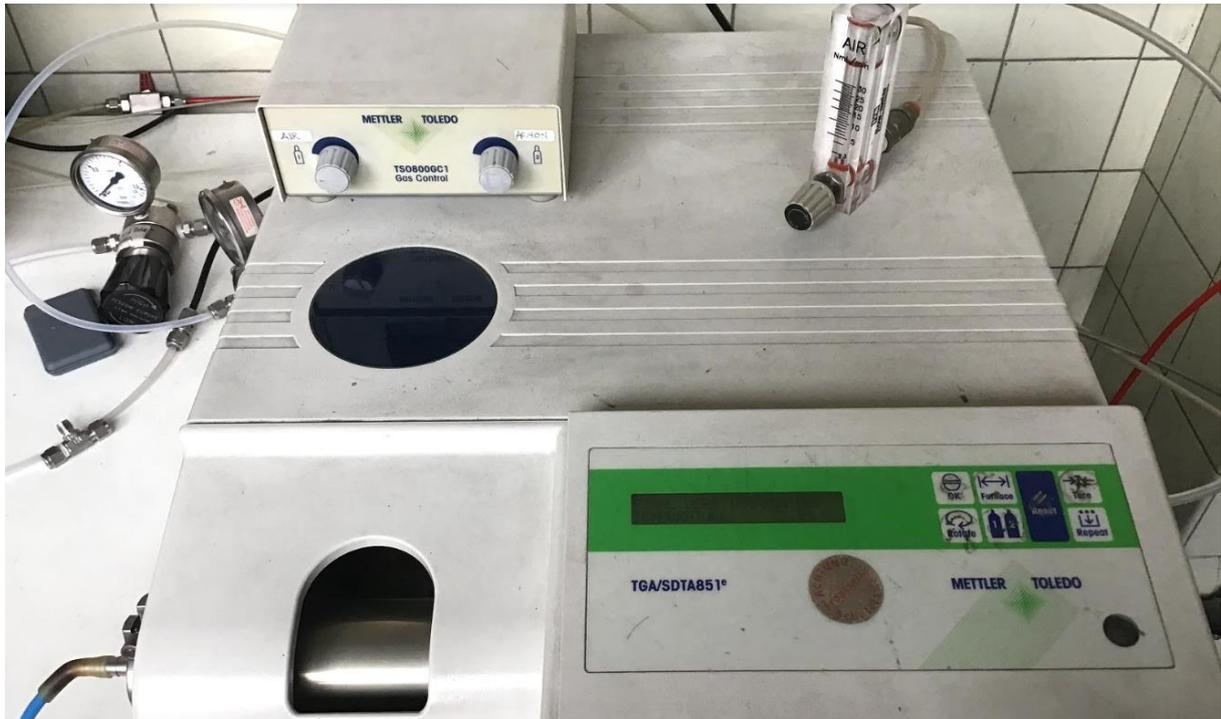
**Figura 4.9:** TGA/SDTA851° utilizzato per le prove termogravimetriche.
