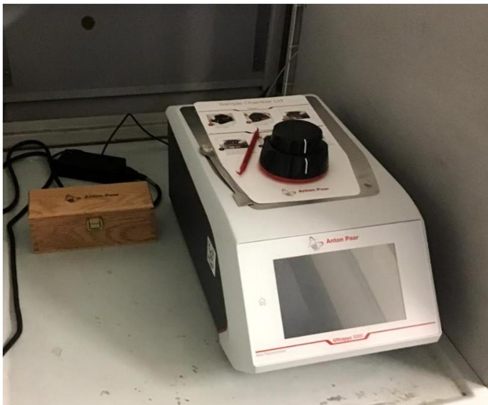
**Figura 4.11:** Ultrapyc 5000, picnometro ad elio utilizzato per le prove densimetriche.
