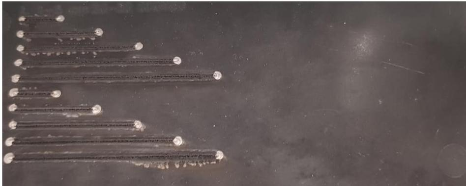
**Figura 4.17:** esempio di campione sottoposto a trattamento laser con piste di diversa lunghezza.
