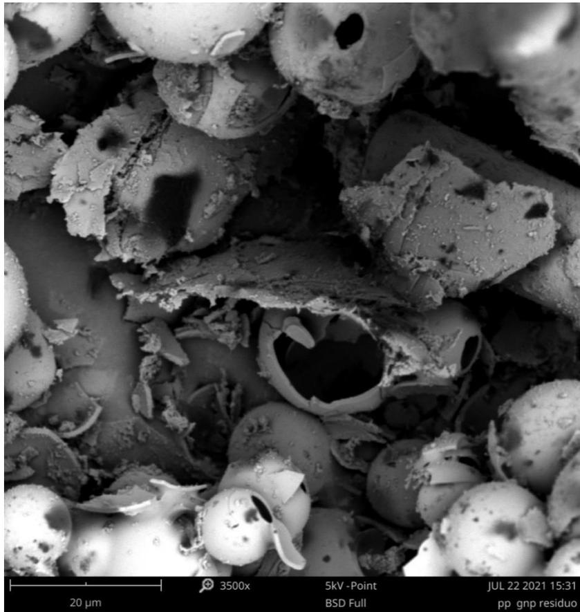
**Figura 5.17:** micrografia SEM del residuo.
