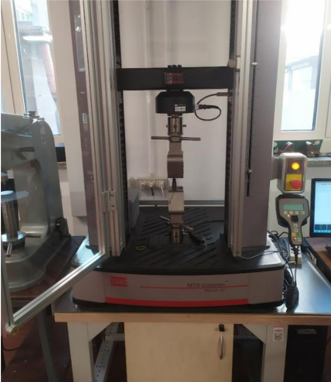
**Figura 4.19:** Strumento per prove di trazione Model 43 MTS Criterion.
