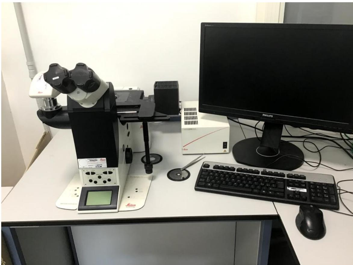
**Figura 4.4:** microscopio ottico Leica Microsystems utilizzato per caratterizzare la microstruttura.
