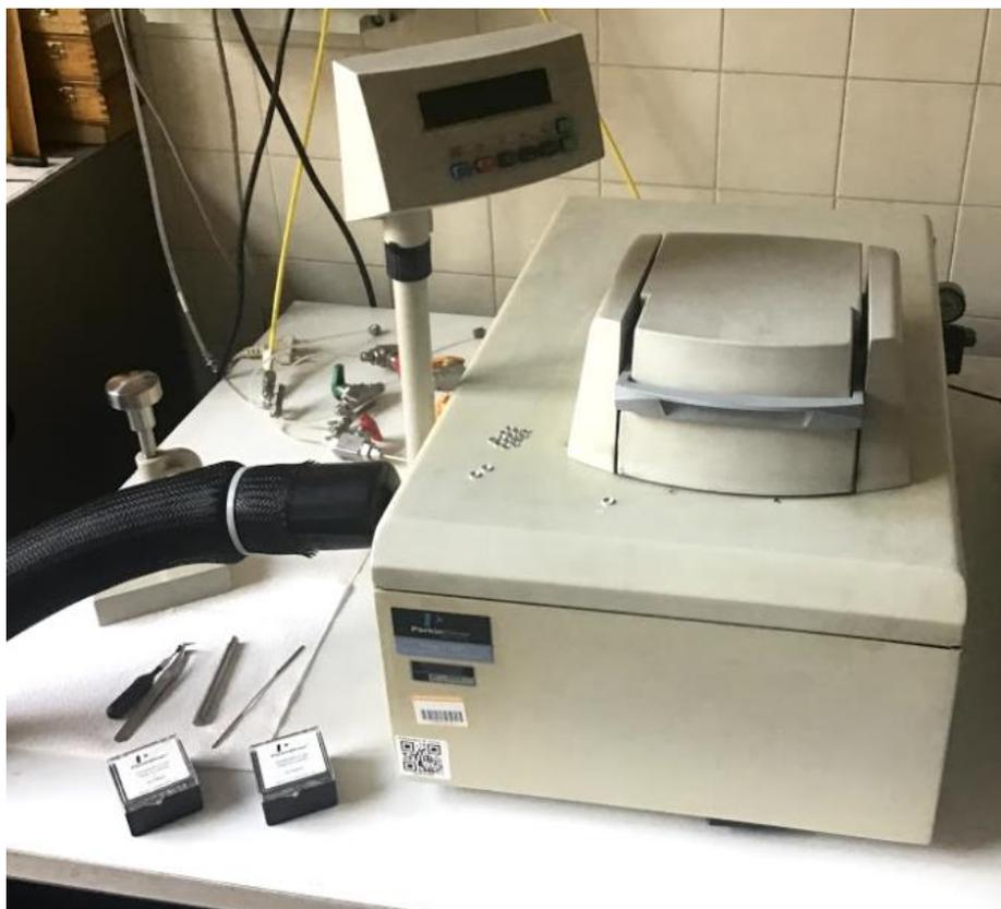
**Figura 4.8:** calorimetro differenziale a scansione (DSC) Pyris 1.
