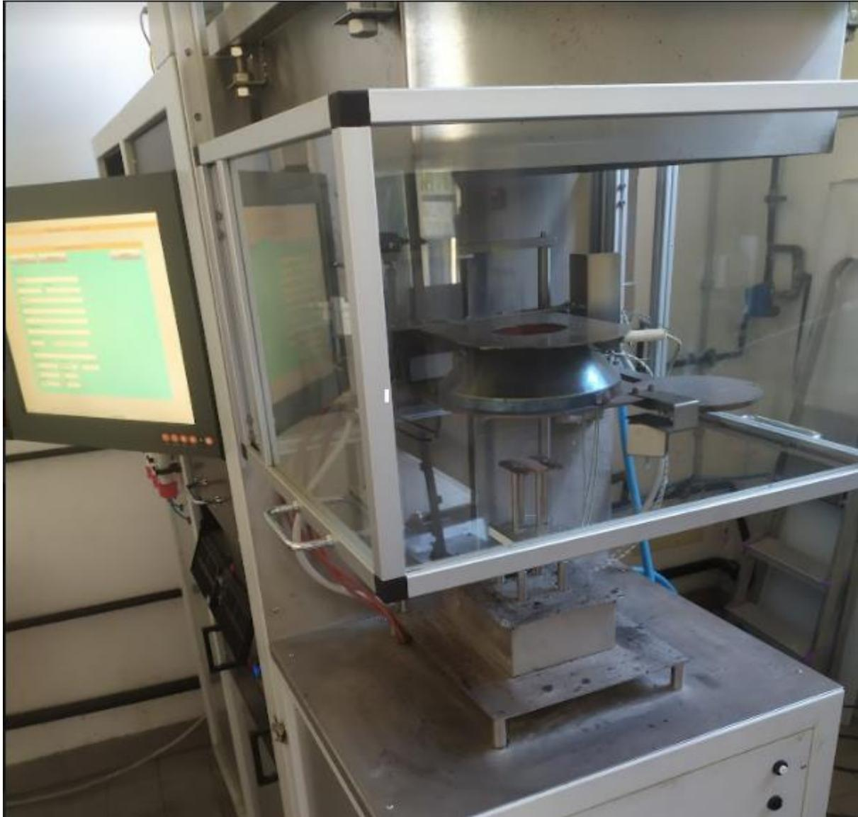
**Figura 4.20:** cono calorimetrico a consumo di ossigeno.
