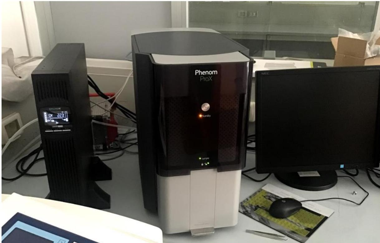
**Figura 4.6:** microscopio elettronico a scansione ProX.
