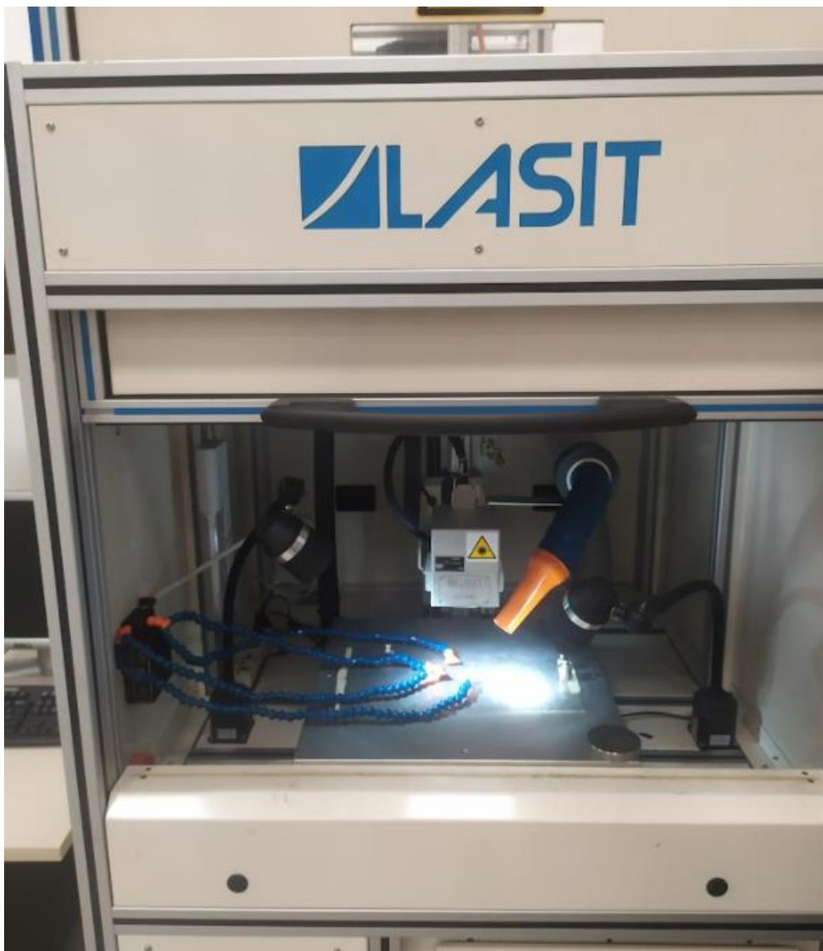
**Figura 4.15:** laser a CO<sub>2</sub> Towermark XL prodotto da LASIT S.p.a.
