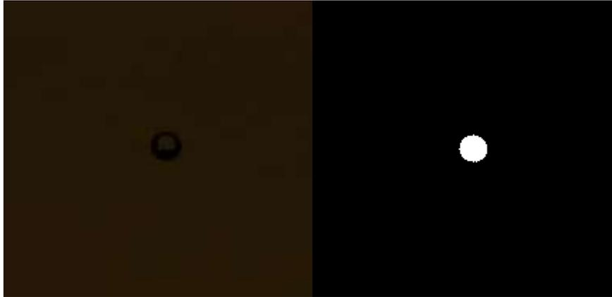
*Figura 4.2. Esempio di goccia in caduta, formata da ago a sezione orizzontale 25G e da 13mm prima e dopo elaborazione.*
