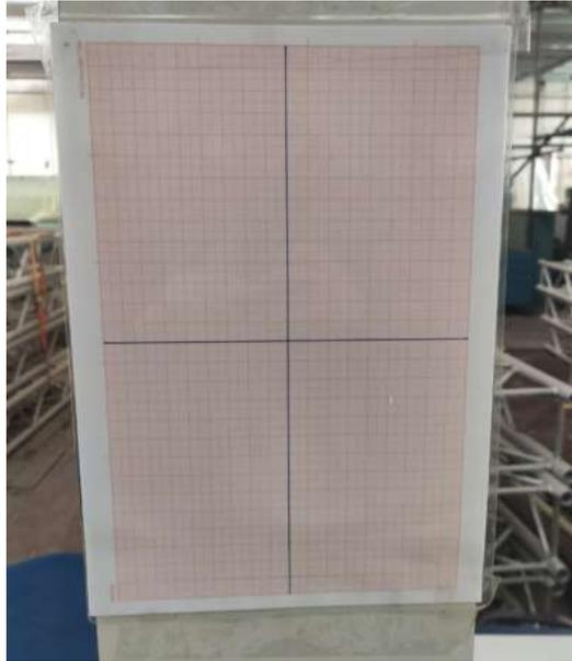
*Figura 4.3. Foto del target millimetrato per la calibrazione delle immagini.*
