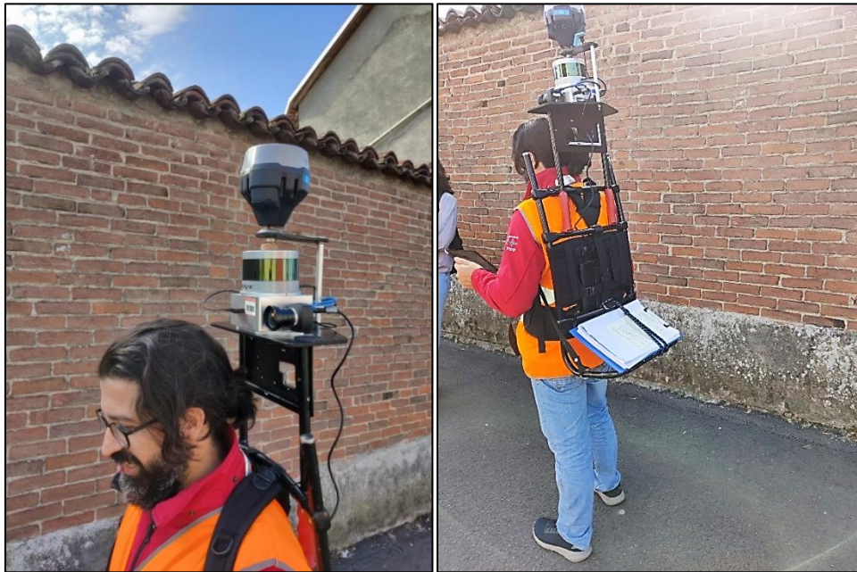
Figura 16 LIDAR + GPS montati su struttura mobile
