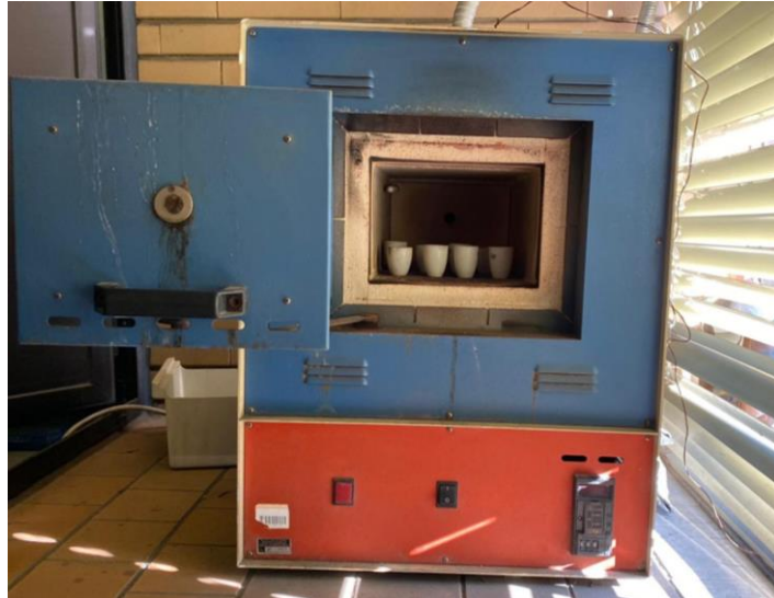
Figura 2.4 Forno a muffola con i crogioli contenenti i campioni analizzati
