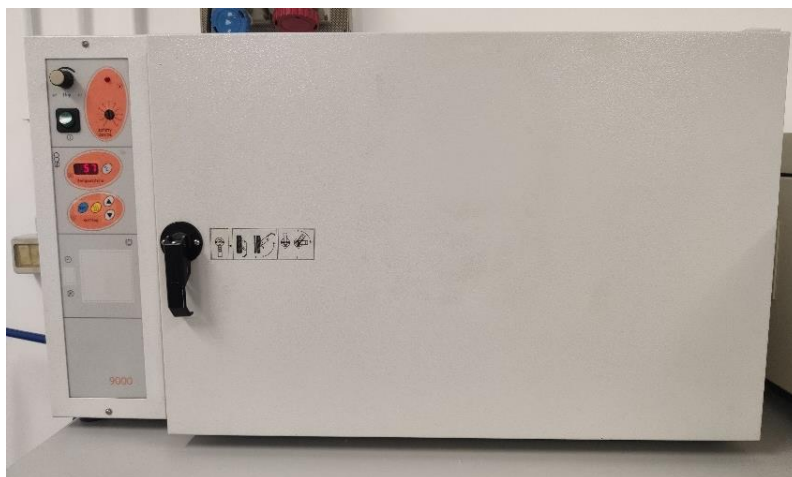
Figura 2.2 Stufa utilizzata per l'analisi del contenuto di umidità
