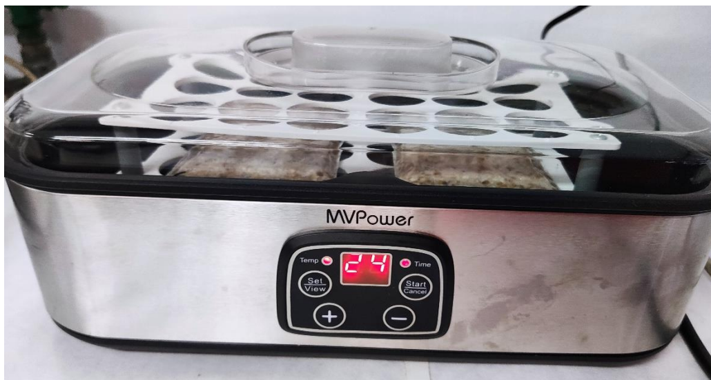
Figura 2.13 Termostato utilizzato per le fermentazioni
