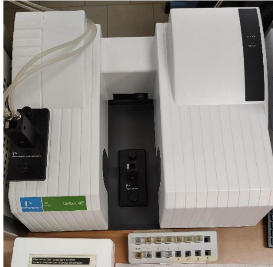
Figura 2.23 Spettrofotometro utilizzato per le analisi di concentrazione di proteine
