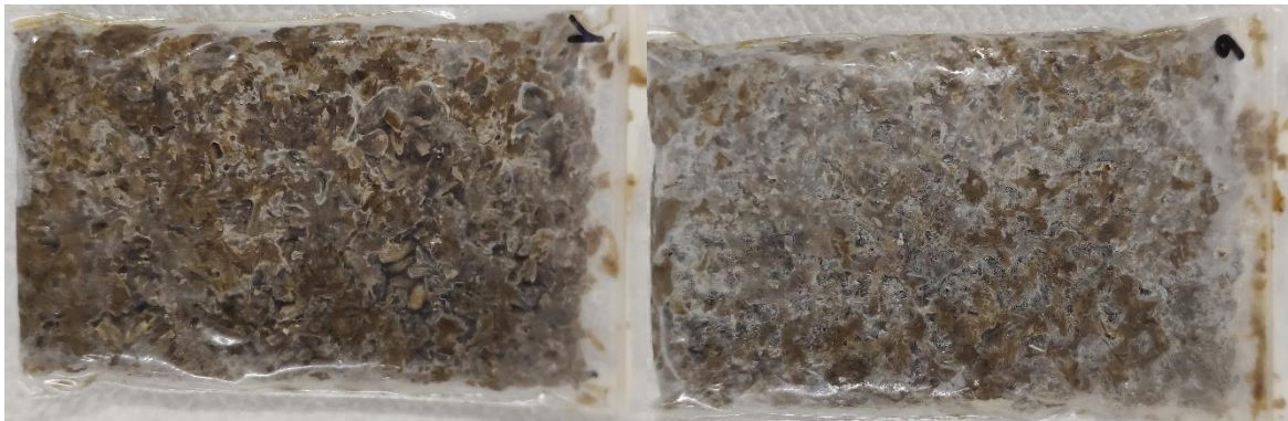
Figura 3.13 confronto tra un sistema con inoculazione al 10% (v/m) (a sinistra) rispetto ad uno con inoculazione al 15% (v/m) (a destra) incubati in un range di temperatura tra 33 e 35°C
