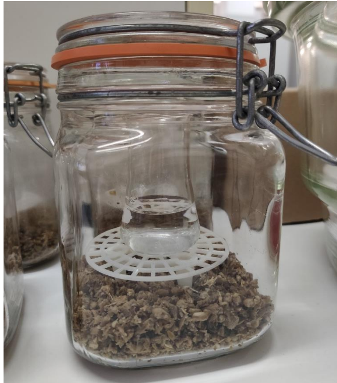
Figura 2.10 Esempio di microcosmo utilizzato per la prova respirometrica
