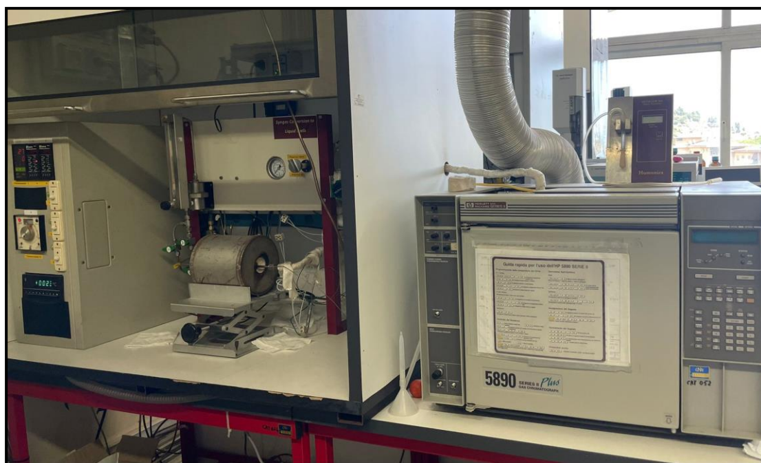
Figura 3.9: Immagine dell'impianto sperimentale utilizzato per le misure di attività catalitica al CNR-ITAE di Messina.
