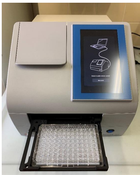
Figura 15. Multiskan Sky Microplate Spectrophotometer, dettaglio piastra a 96 pozzetti impiegata per l'analisi
