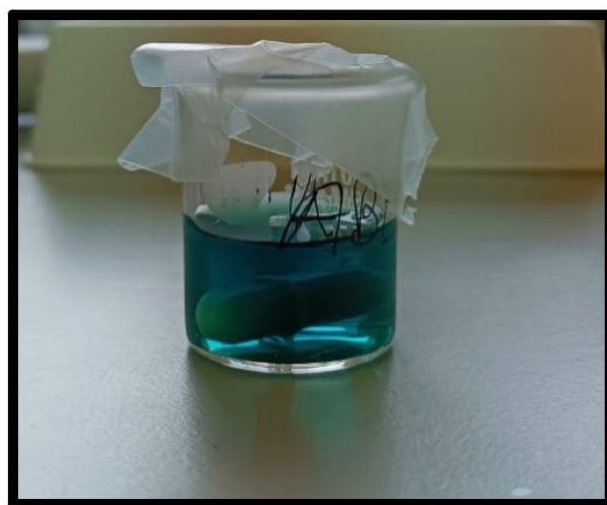
Figura 3.3: Soluzione stock ABTS in buffer citrato 30 mM. La colorazione verde è sinonimo della presenza in soluzione del radicale cationico ABTS^{\cdot+} frutto dell'ossidazione.
