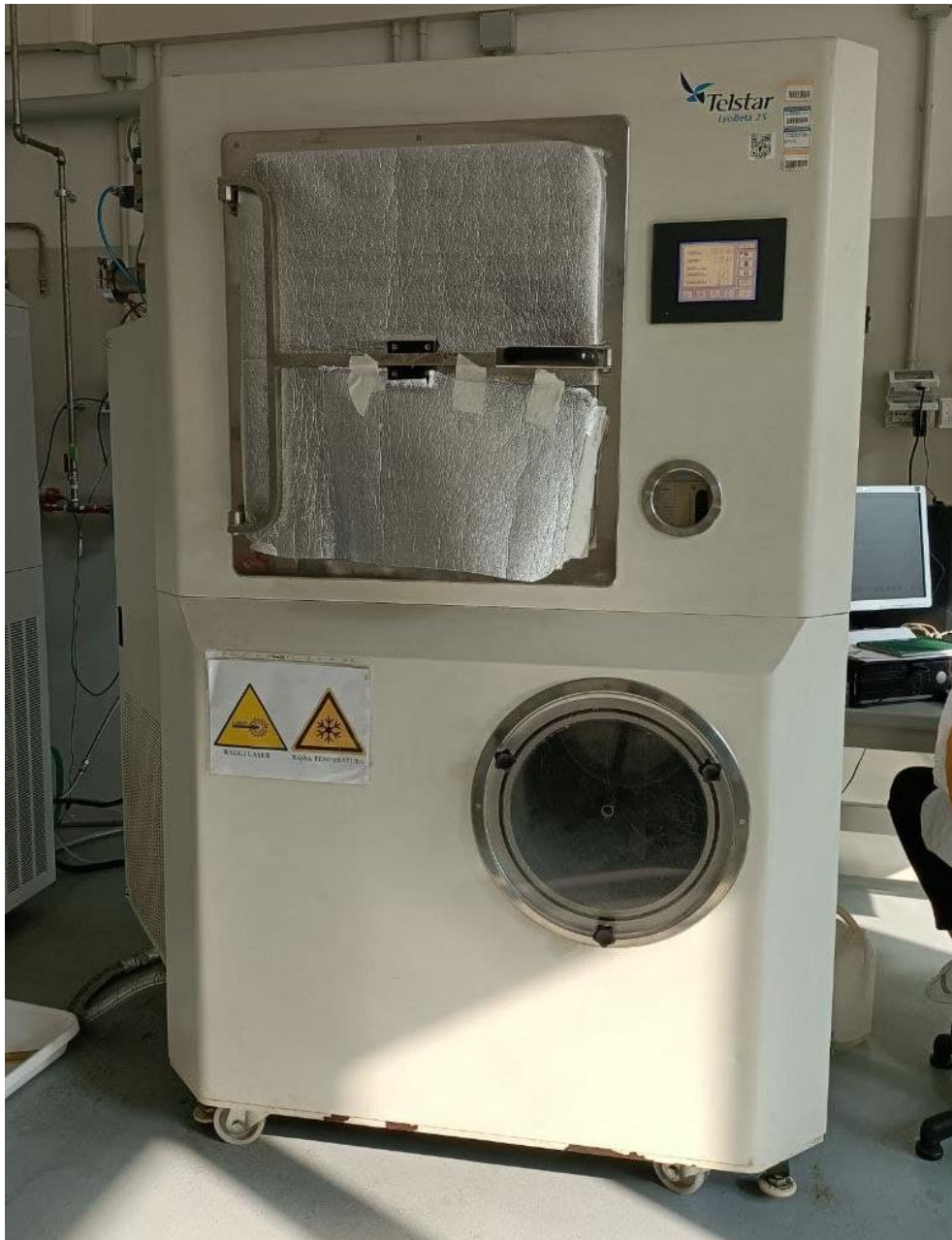
Figura 2.6 - Liofilizzatore Telstar Lyobeta 25 utilizzato per le prove sperimentali e presente nei laboratori del DISAT.
