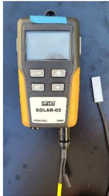
Figura 8.9. Sonda di temperatura per misurare il valore della temperatura della cella fotovoltaica
