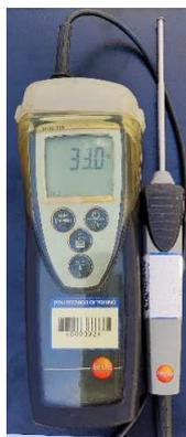
Figura 8.8. Sonda di temperatura per misurare il valore della temperatura ambientale
