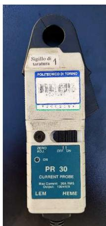
Figura 8.7. Sonda di corrente ad effetto Hall, saranno presenti due sonde in fase di misura
