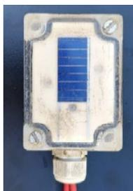
Figura 8.11. Cella fotovoltaica per la misura dell'irradianza perpendicolare
