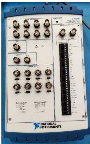
Figura 8.12. Strumento per l'acquisizione dei valori misurati (NI USB-6251 BNC)
