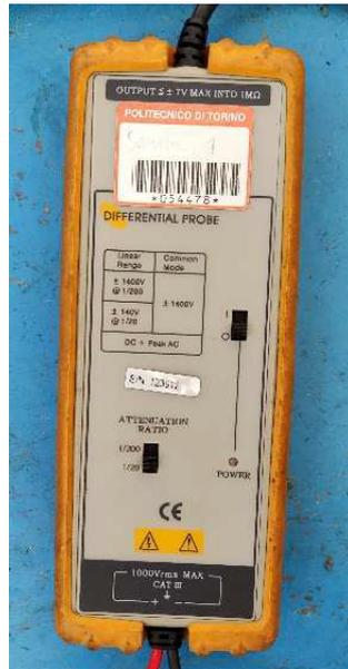
Figura 8.6. Sonda differenziale di tensione, posizionata sui morsetti del modulo
