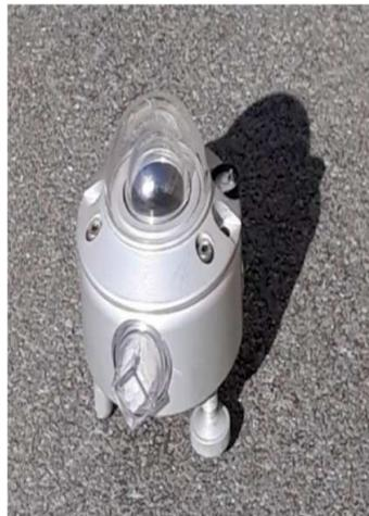
Figura 8.10. Si nota lo strumento per avere la misura dell'irradianza in tutte le sue componenti, il piranometro
