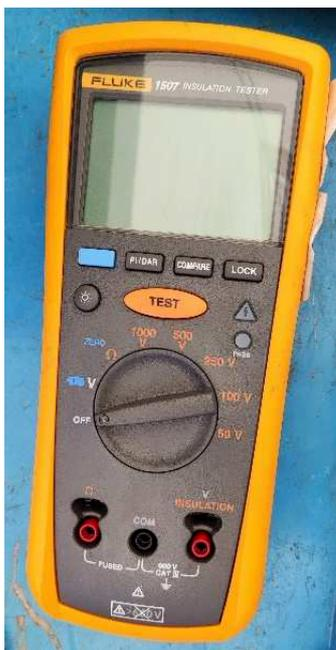
Figura 8.2. Fluke 1507 strumento di misura utilizzato per valutare la resistenza di isolamento
