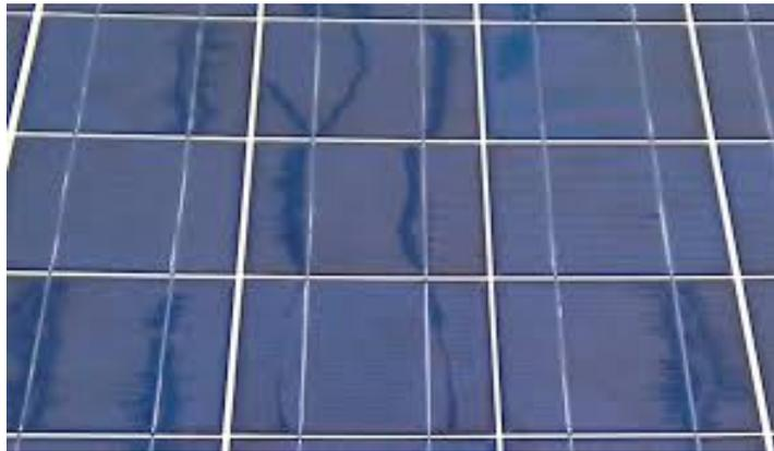
Figura 6.5. Notiamo le Simple snail trails grazie all'andamento delle linee che attraversano la cella, mentre ai lati della cella risultano evidenti i framing snail trails
