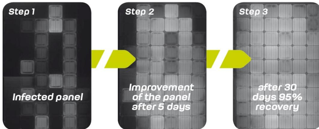
Figura 6.3. Procedura di recupero del pannello dal difetto dovuto al PID
