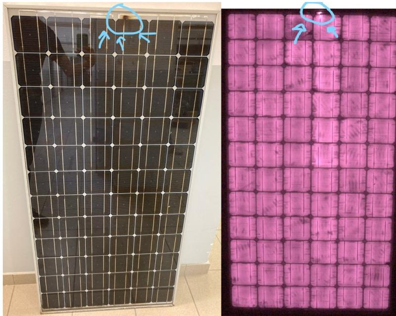
Figura 8.4. Sulla sinistra si nota una piccola bruciatura, che causa nella figura di destra un hot spot, verificato tramite il test di EL
