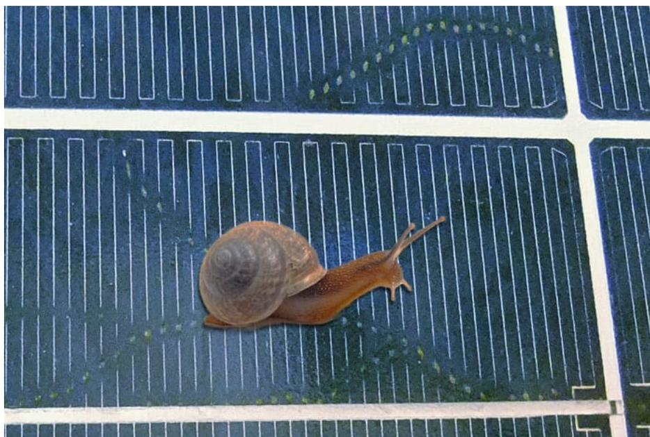
Figura 6.4. Similitudine crepa nel pannello fotovoltaico con la scia di una lumaca
