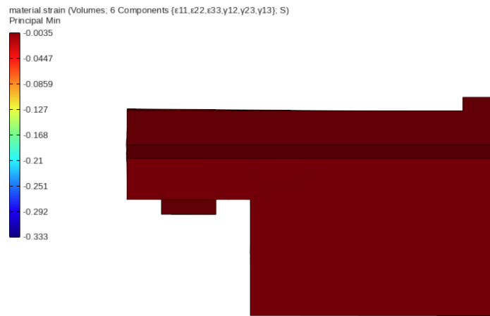
Figura 5.53 - Step 20, deformazione minima del calcestruzzo all'inizializzazione del crack
