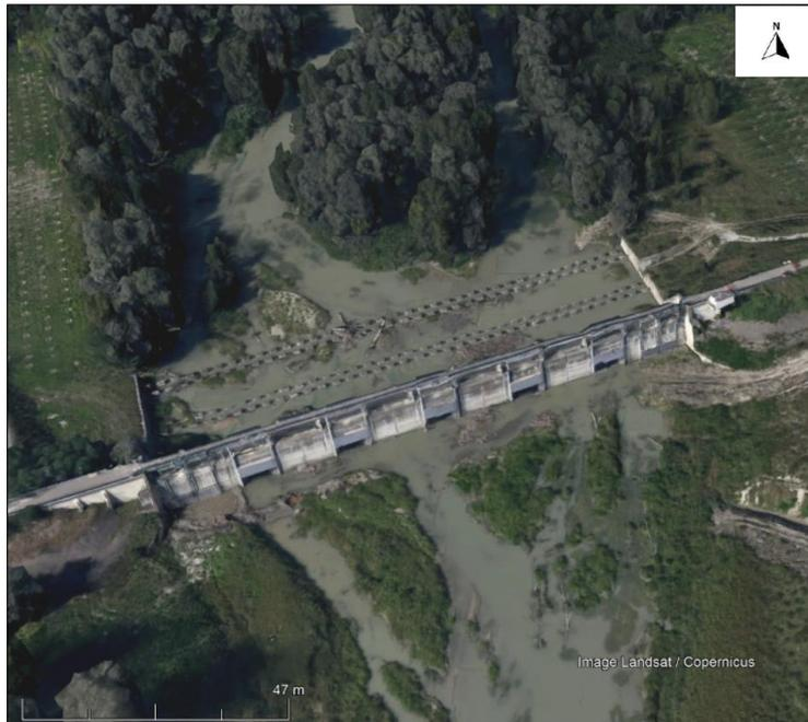
**Figura 4.4** Vista tridimensionale da Google Earth del manufatto principale e della vasca di dissipazione
