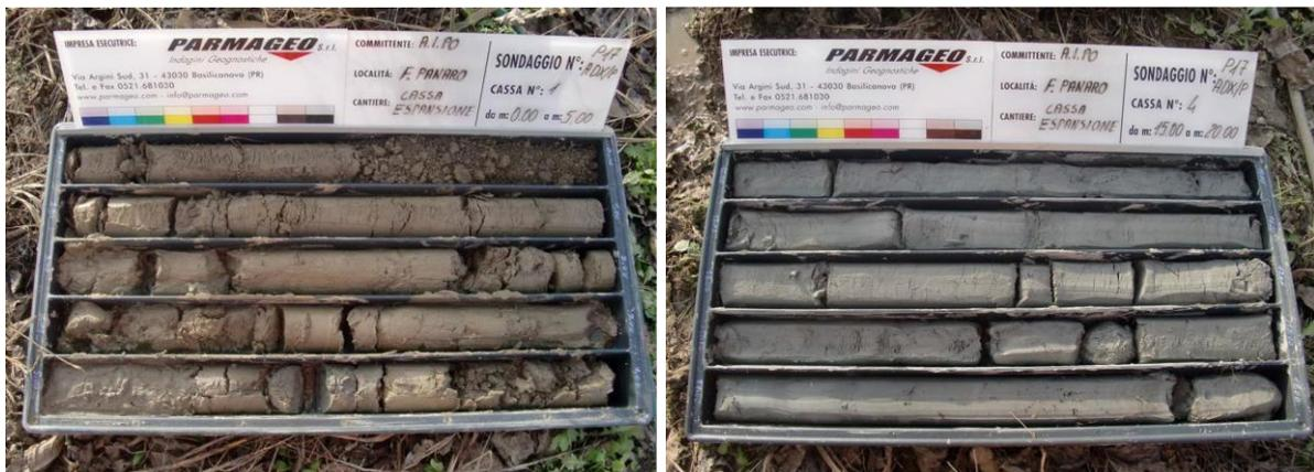
Figura 4.12 Sondaggio nella sezione arginale 17 al piede ed alcune foto del carotaggio
