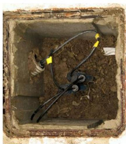
Figura 4.18 Segnaletica dei piezometri nella sezione arginale 14 con zoom in quello al piede
