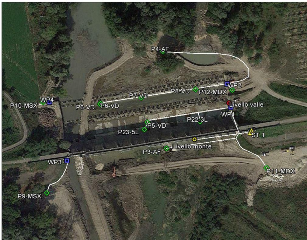
**Figura 4.17** Distribuzione dei piezometri nell'opera di sbarramento
