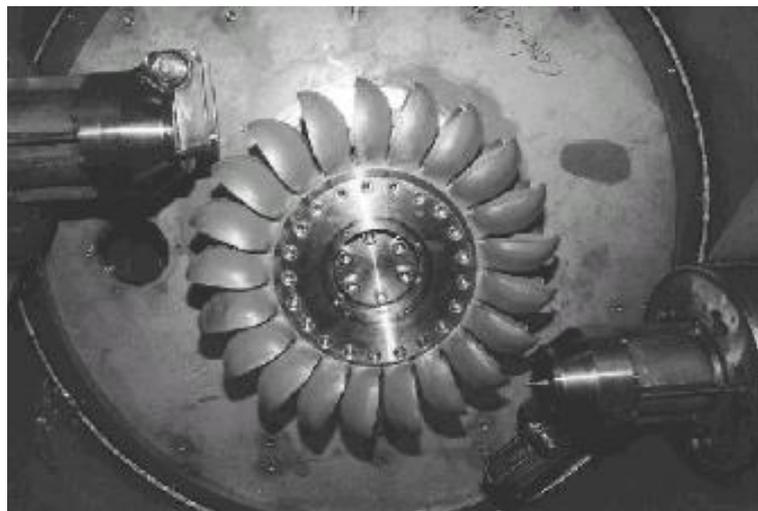
*Figura 4.25 – Girante di una turbina Pelton*
