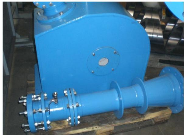
Figura 4.34 – Tubo a parete e turbina
