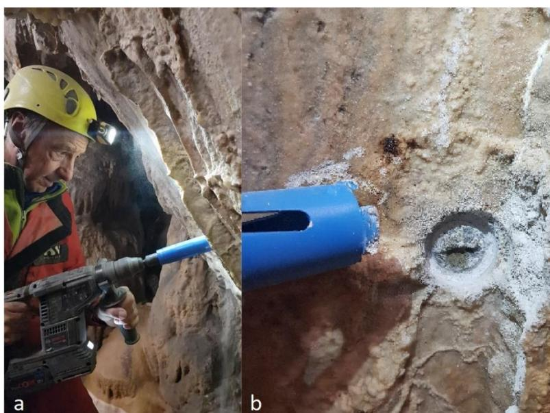
*Figura 5.19 – Tentativo di carotaggio all'interno della grotta di Bossea lungo la parete. a) Perforazione con il trapano e con carotiere di diametro 38 mm. b) Foro ottenuto con la perforazione e materiale deteriorato.*
