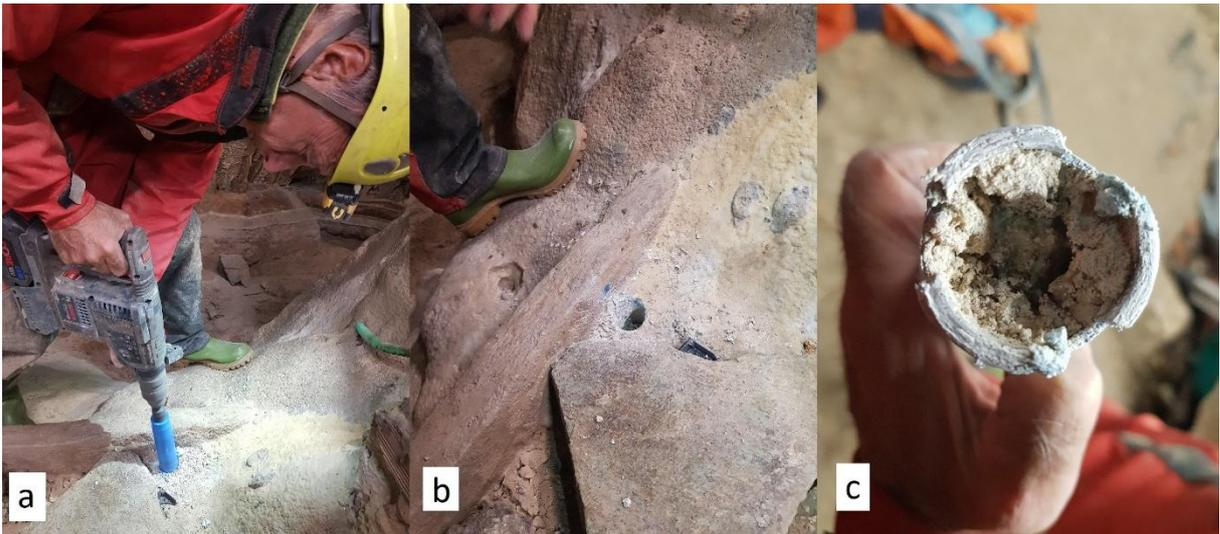
*Figura 5.20 – Tentativo di carotaggio all'interno della grotta di Bossea sulla pavimentazione. a) Perforazione con il trapano e con carotiere di diametro 38 mm. b) Risultato della perforazione. c) Materiale disgregato presente all'interno del carotiere.*
