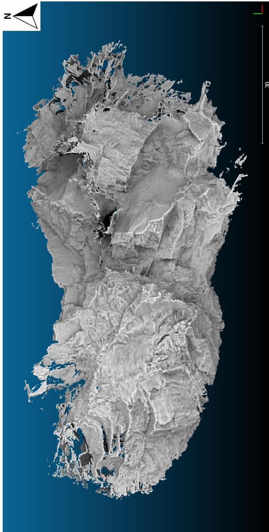
*Figura 5.5 – Nuvola di punti della Sala dell'Orso osservata sul software CloudCompare.*
