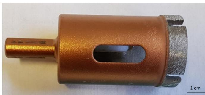
Figura 5.17 – Carotiere 1 (diametro: 35 mm, lunghezza: 85 mm).
