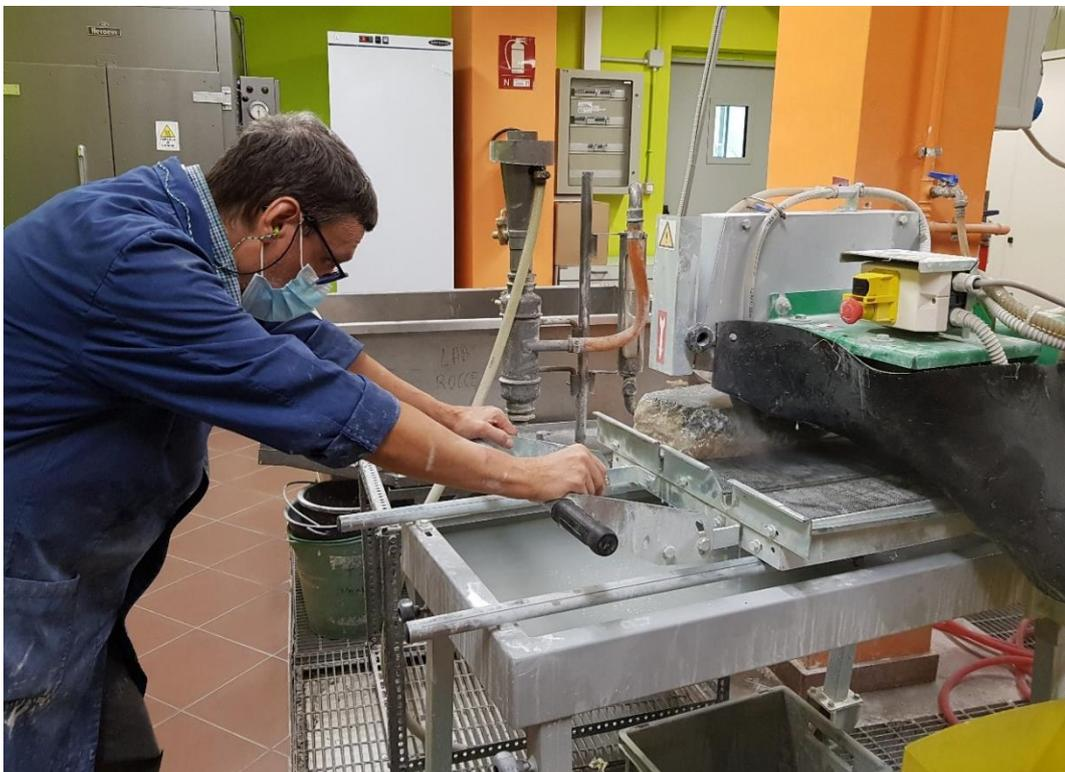
*Figura 5.26 – Fase di taglio dei blocchi con la sega circolare con lama che presenta un'altezza utile di 12,5 cm.*
