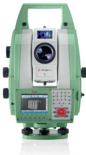
Figura 2.1 - Stazione totale robotizzata Leica Nova MS50. [w3.leica-geosystems.com]
