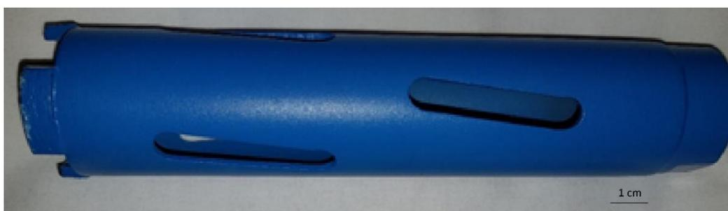
Figura 5.18 – Carotiere 2 (diametro: 38 mm; lunghezza: 200 mm).
