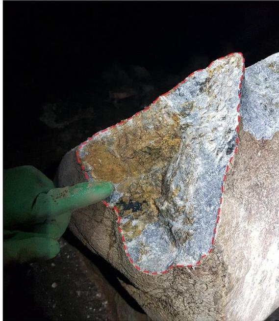
*Figura 5.23 – Zona di distacco del blocco di roccia 2.*
