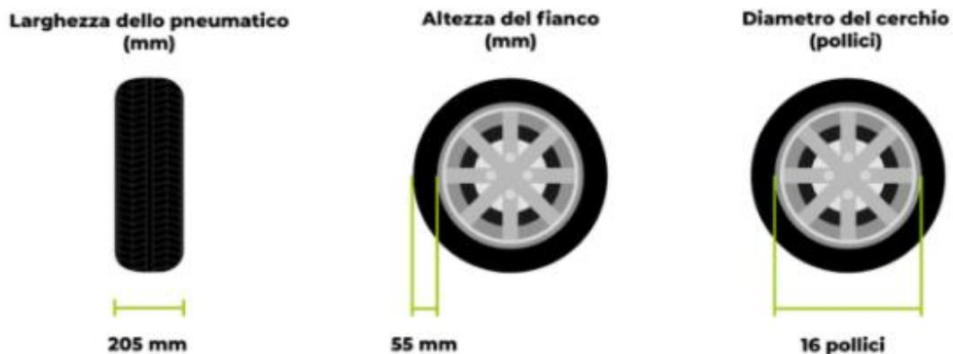
Figura 2: La marcatura tecnica dello pneumatico
