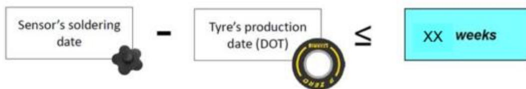
Figura 41: Rappresentazione della logica adottata per la tolleranza di aging del sensore (fonte propria)
