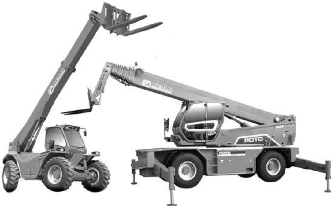
Figura 2.8 – Sollevatore telescopico frontale, a sinistra, e rotativo, a destra (fonte interna)
