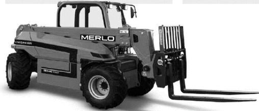
**Powertrain:** La trasmissione dell'e-Worker è 100% elettrica ed è formata da una batteria che alimenta direttamente i motori elettrici, in modo da garantire una coppia molto abbondante e costante per tutta la fase di accelerazione. Velocità massima di 25 km/h!
