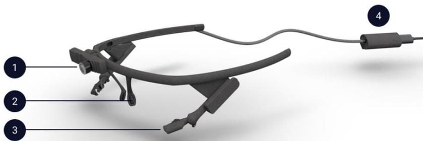
**Figura 4- 1:** Strumento di eye-tracking PUPIL core. Gli elementi rappresentano: 1) Videocamera frontale, 2) Supporti nasali, 3) Videocamera degli occhi, 4) Attacco USB per trasferire i dati acquisiti durante la registrazione ad un qualsiasi dispositivo esterno (Pupil Labs, 2014).
