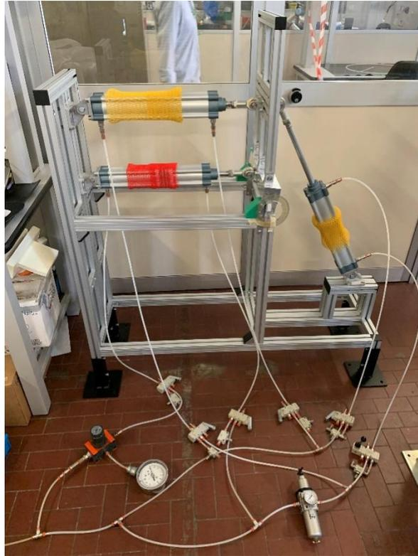
*Figura 9.11: Circuito pneumatico ad azionamento elettrico realizzato nei laboratori del DIMEAS.*
