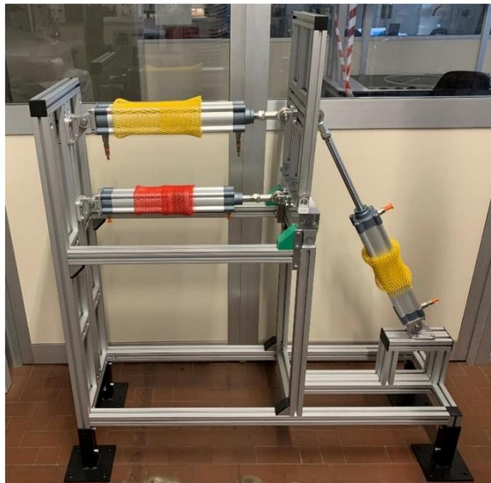
*Figura 3: Fotografia del banco prova per esoscheletri posturali presente nei laboratori del DIMEAS.*
