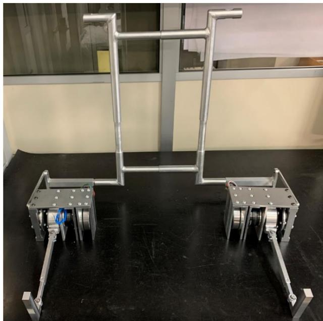
*Figura 1: Fotografia dell'esoscheletro posturale ad azionamento elettrico per uso industriale ottimizzato e costruito durante lo sviluppo di questo progetto di tesi.*
