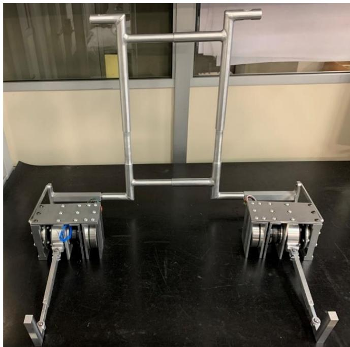
*Figura 2.1: Exoscheletro ad azionamento elettrico costruito durante lo sviluppo di questo elaborato di tesi.*
