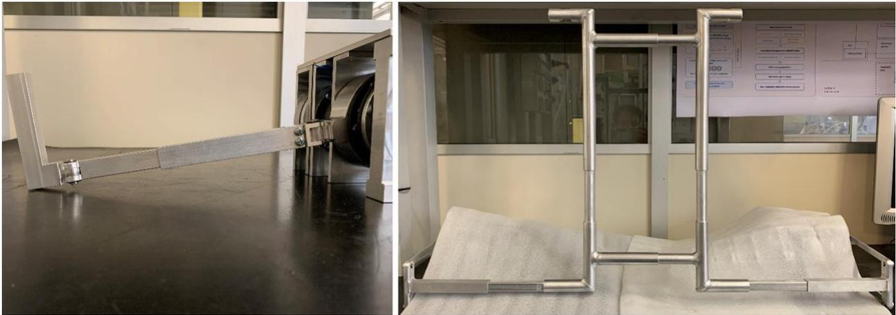
*Figura 6.7: Leg-link e back-frame configurati per adattarsi ad un individuo appartenente al 95 percentile totale della popolazione italiana.*
