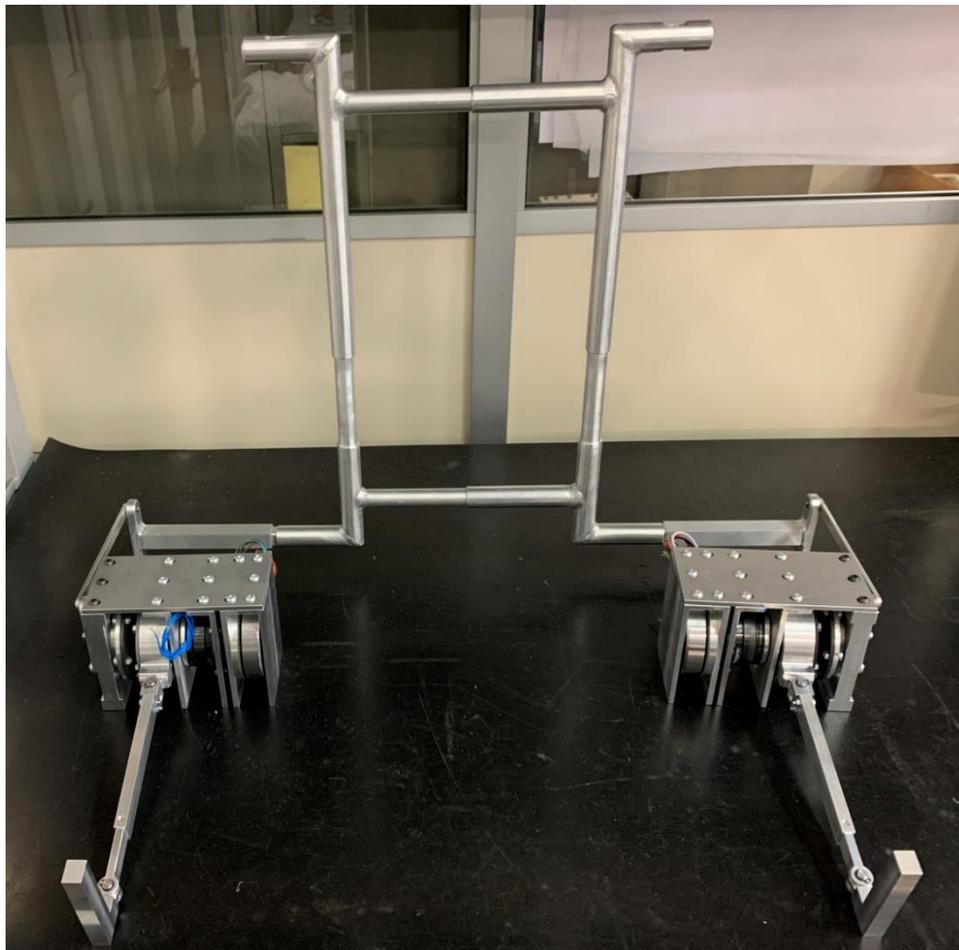
Figura 5.17: Assemblaggio completo dell'esoscheletro, fotografia scattata nei laboratori del DIMEAS.
