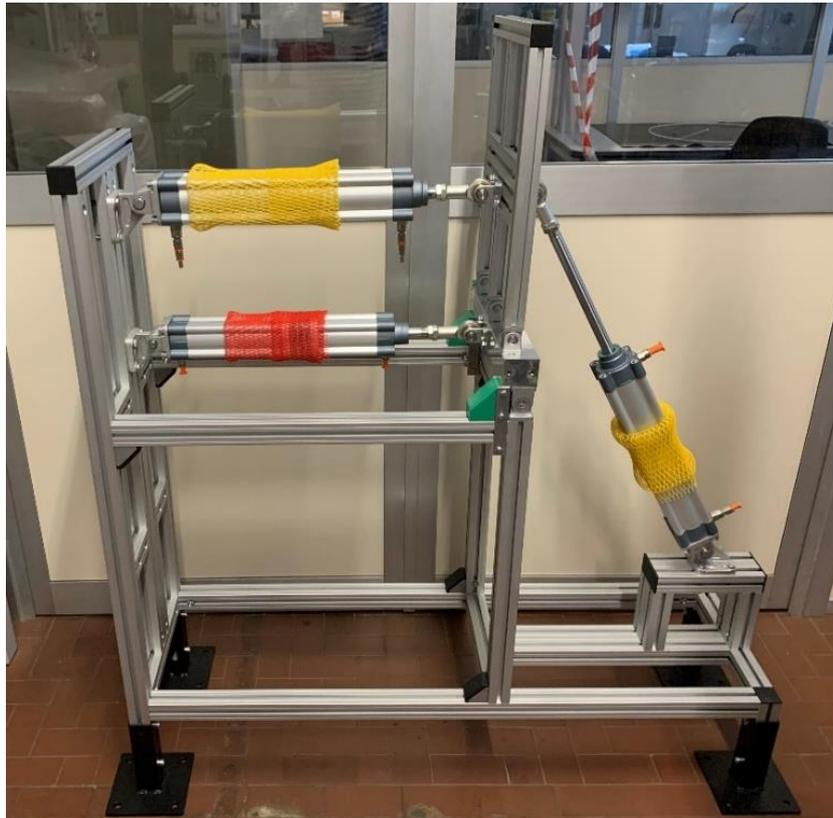
*Figura 8.1: Fotografia del banco prova esoscheletri presente nei laboratori del DIMEAS.*
