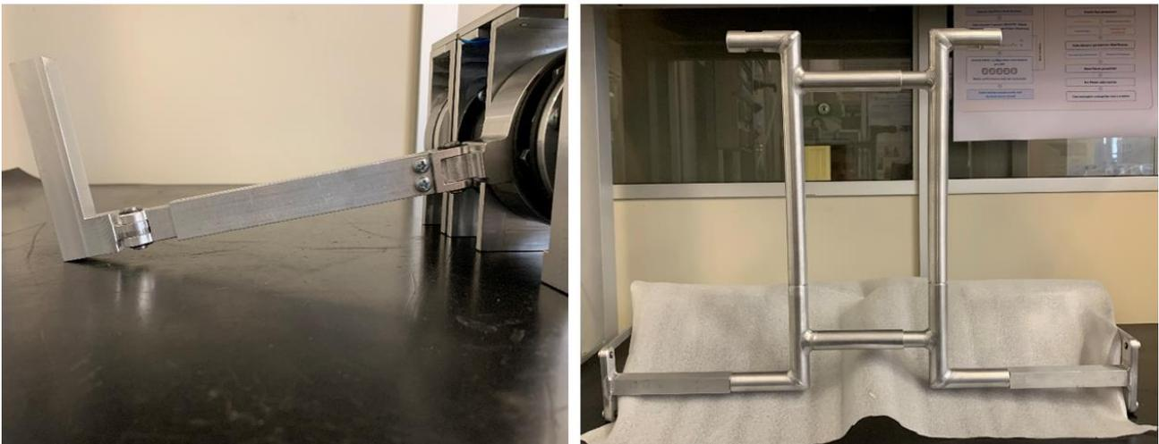
*Figura 6.6: Leg-link e back-frame configurati per adattarsi ad un individuo appartenente al 5 percentile totale della popolazione italiana.*
