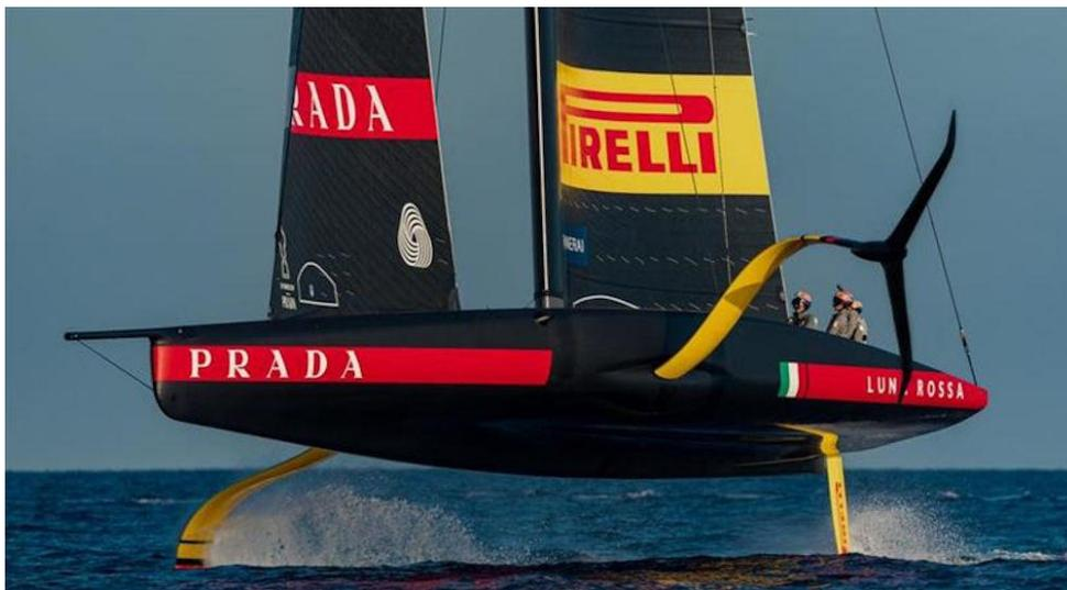
Figura 1.2. Esempio di imbarcazione "foilante": Luna rossa (America's cup)
