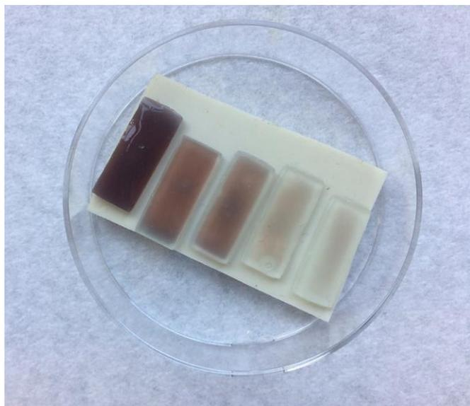
*Figura 3.16* Idrogeli M-CMC/5% S4BCu a diversi tempi trascorsi dal termine dell'irraggiamento. L'idrogelo più a destra è appena stato irraggiato, mentre l'ultimo a sinistra è stato reticolato oltre 10 minuti prima dello scatto della foto.
