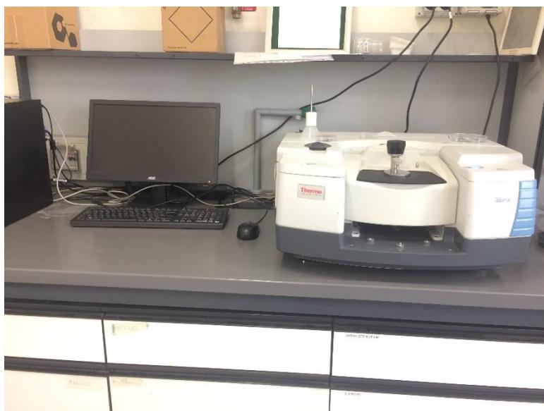
*Figura 3.17* Strumentazione utilizzata per l'analisi FTIR
