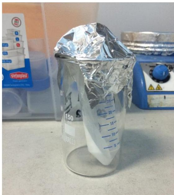
*Figura 3.11* Sistema predisposto per il trattamento in stufa
