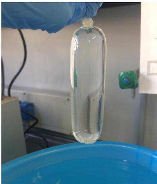
*Figura 3.8* Membrana contenente la soluzione di M-CMC al termine della dialisi
