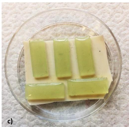
Figura 3.15 Idrogeli GelMA/5% S4: a) prima dell'irraggiamento b) subito dopo l'irraggiamento c) 10 minuti dopo la fotoreticolazione
