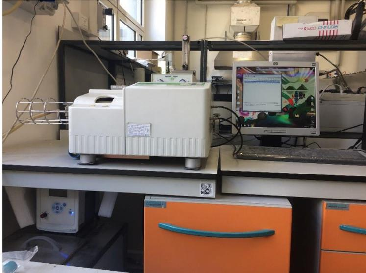
*Figura 3.20* Strumentazione utilizzata per l'analisi termogravimetrica
