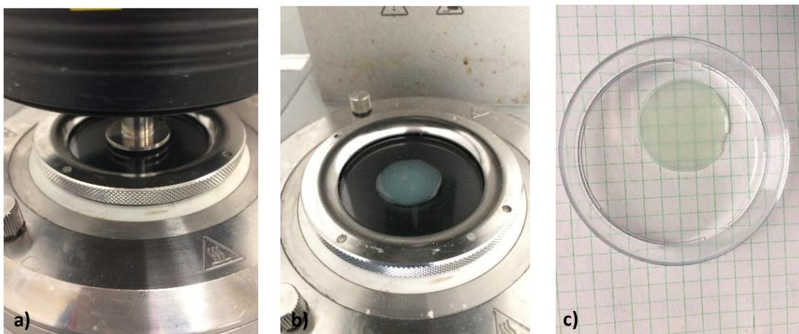
Figura 3.18 a) Reometro utilizzato per le misurazioni; b) Posizionamento della dispersione sulla base del fotoreometro; c) Campione ottenuto al termine della prova
