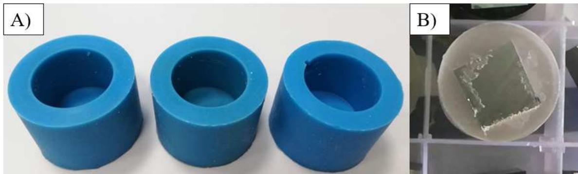
Figura 4.23 A) Formelle in silicone per inglobatura a freddo B) Struttura provino dopo inglobatura a freddo
