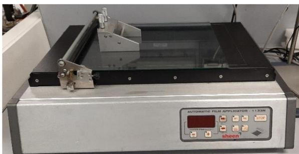
Figura 3.2 Applicatore di film automatico.
