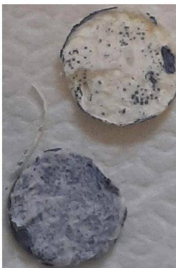
Figura 4.22 Analisi *post-mortem* di cella standard dopo test di soppressione dendriti.
