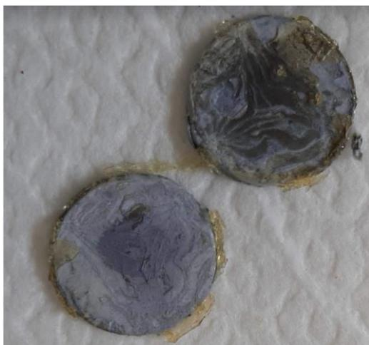
Figura 4.23 Analisi post-mortem dopo test di soppressione dendriti dell'elettrolita 70/20/10.
