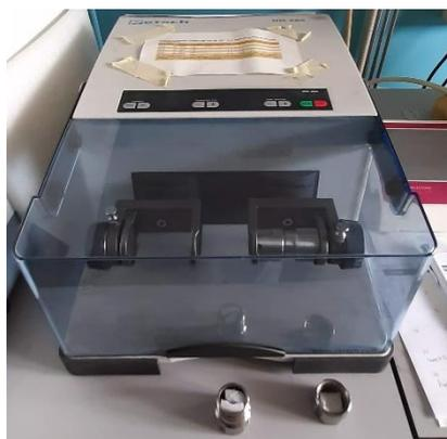
Figura 3.1 Vibromulino Retsch® MM40.
