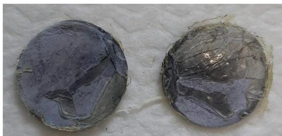
Figura 4.24 Analisi post-mortem dopo test di soppressione dendriti dell'elettrolita 70/20/10+KPF<sub>6</sub>.
