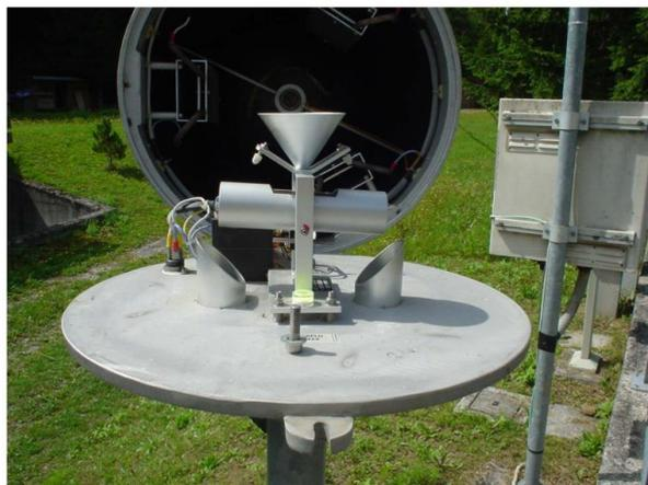
*Figura 3.7 - Interno del pluviometro a bascula
