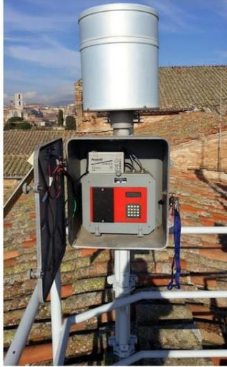
*Figura 3.9 - Pluviometro con data logger digitale
