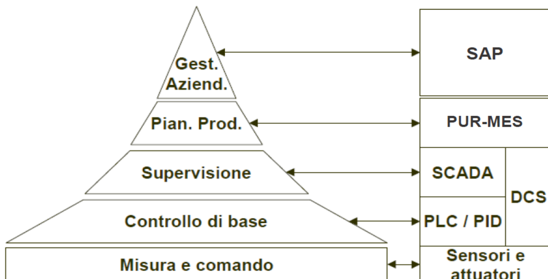
Figura 4.1 Schema di gestione dell'automazione dell'impianto.
