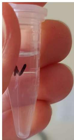
Figura 3.12: Nanoparticelle di chitosano dsRNA prodotte a partire da 0.5 \frac{g}{l} di chitosano e 10 \mu g di dsRNA sedimentate al seguito di una centrifugazione condotta a 16000 RPM per la durata di 15 minuti.
