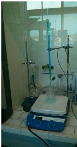
**Fig. 3.1.** Apparato sperimentale utilizzato per la preparazione di sistemi catalitici coprecipitati.
