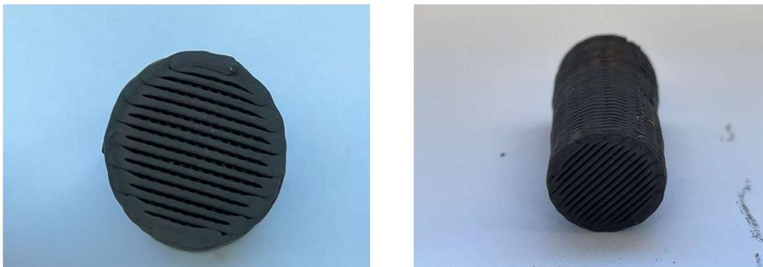
**Fig. 3.5.** Foto del sistema catalitico 3D preparato mediante micro-estruzione.
