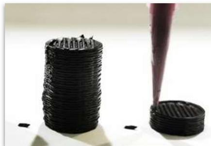
**Fig. 3.4.** Rappresentazione della tecnica di micro-estrusione 3D.
