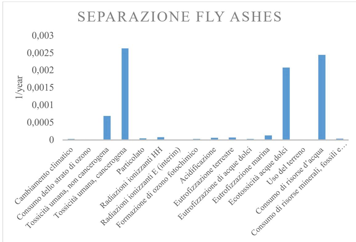
**Figura 4.7:** Normalizzazione dei risultati relativi alla separazione delle fly ashes dai gas di incenerimento, nel caso di utilizzo di bottom ashes con recupero termico
