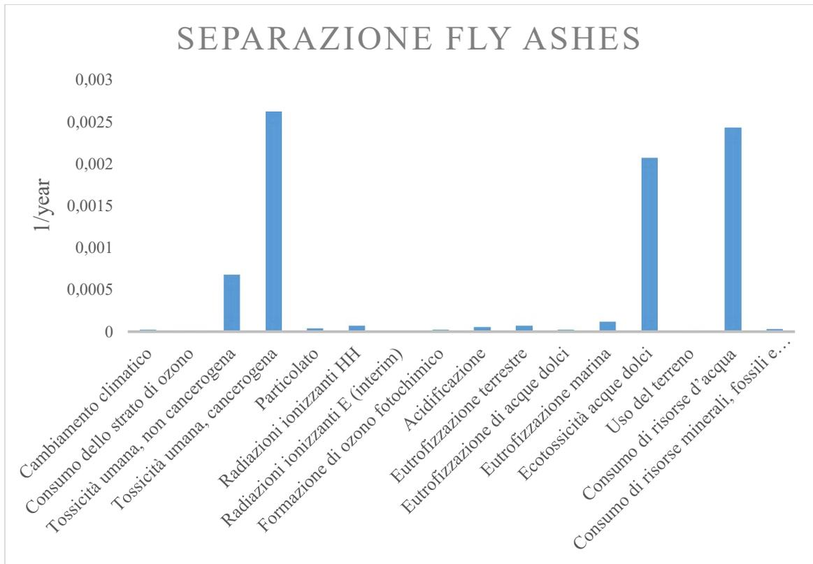
**Figura 4.13:** Dati normalizzati relativi alla separazione delle fly ashes, nello scenario in cui si aggiungono glass cullets in assenza di recupero termico sulle ceneri.
