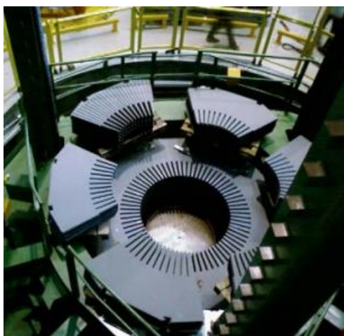
Figura 1. 4 : Procedura di posizionamento lamierini
