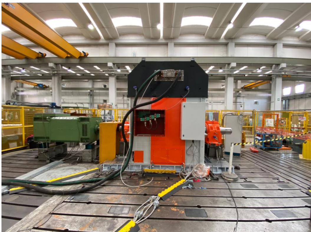
Figura 5. 2 : Generatore sincrono in fase di collaudo
