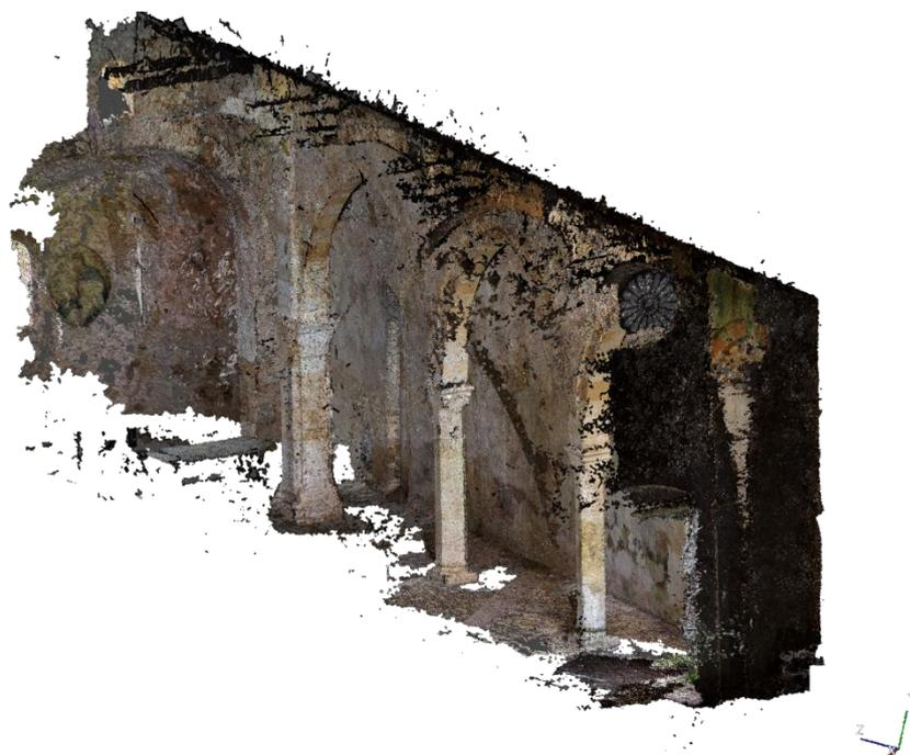
*Fig. 3.2 Nuvola di punti ad alta densità della navata laterale Nord della chiesa.*
