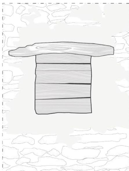
fig. 35. Ridisegno in scala 1:20 di un'apertura quadrata senza infisso "tipo" rilevata tra gli edifici della borgata.
