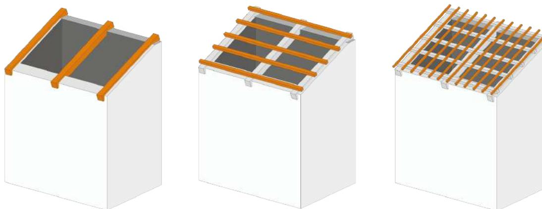
fig. 4. Struttura a puntoni<sup>3-4</sup>
