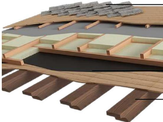
Fig. 32a. Esempio di tetto in legno di nuova costruzione coibentato
