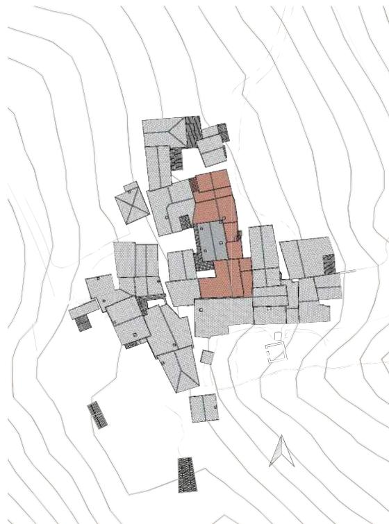
Fig.16. Manica parallela alle isoipse
