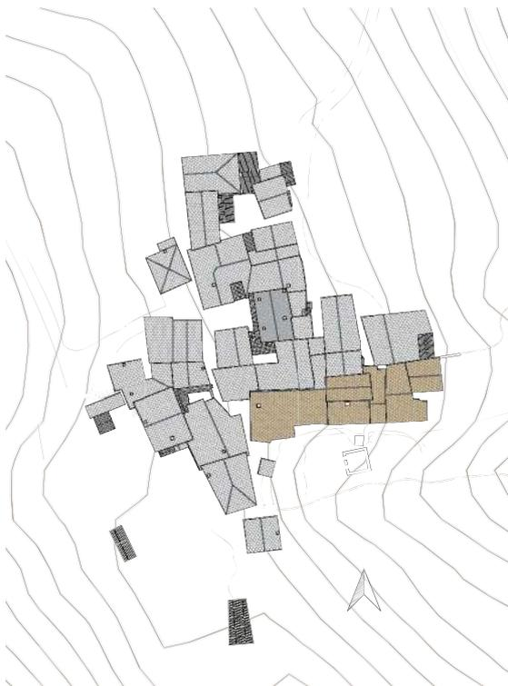
Fig.19. "Manica perpendicolare alle isoipse
