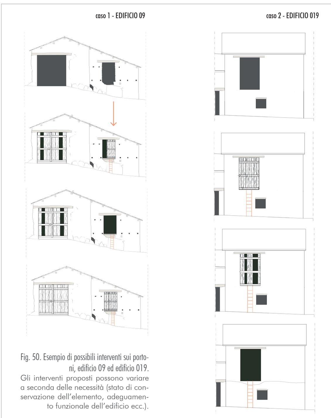
Fig. 50. Esempio di possibili interventi sui portoni, edificio 09 ed edificio 019. Gli interventi proposti possono variare a seconda delle necessità (stato di conservazione dell'elemento, adeguamento funzionale dell'edificio ecc.).
