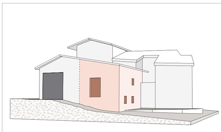
Fig.34. Ampliamento volumetrico con prolungamento della falda<sup>1</sup>
