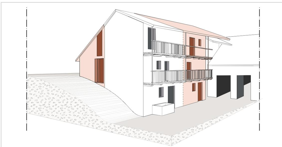
Fig.35. Ampliamento volumetrico con prolungamento della falda parallelo e perpendicolare alle isoipse<sup>3</sup>
