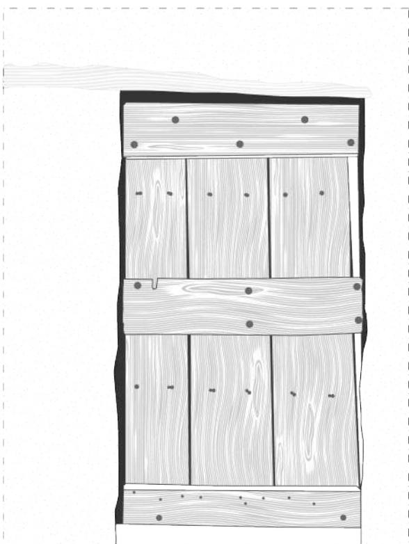
fig. 27. Ridisegno in scala 1:20 di una porta in legno piena "tipo" rilevato tra gli edifici della borgata.
