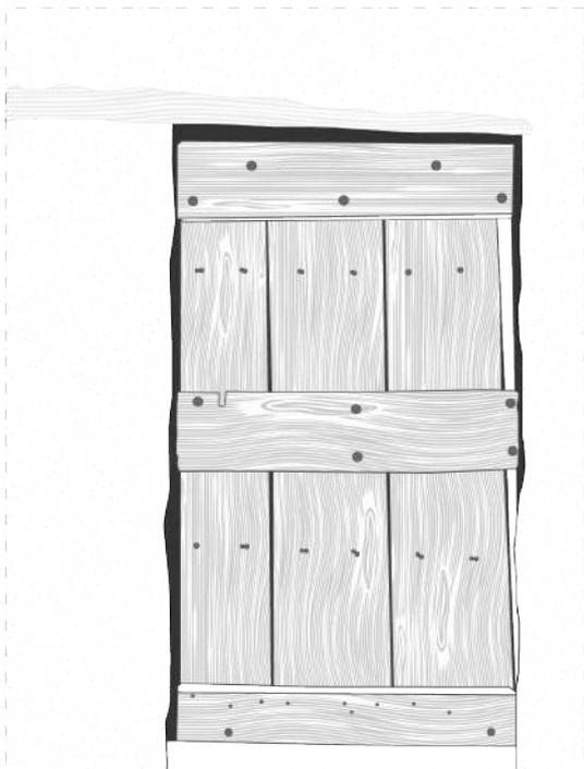
Fig. 51. Esempio di una porta in legno piena modello "tipo".
