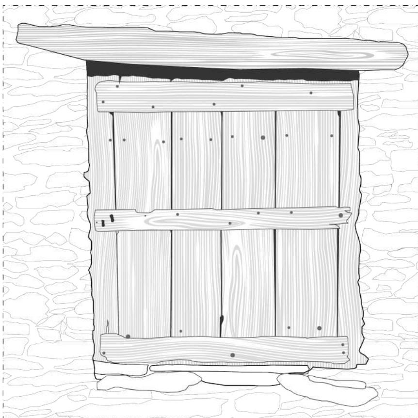
fig. 22. Ridisegno in scala 1:20 di un portone in legno ad anta singola "tipo" rilevato tra gli edifici della borgata.
