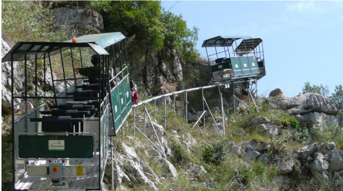
Figura C6.12- Vagoncini trasporto passeggeri e struttura di sostegno (monorotaia)<sup>153</sup>
