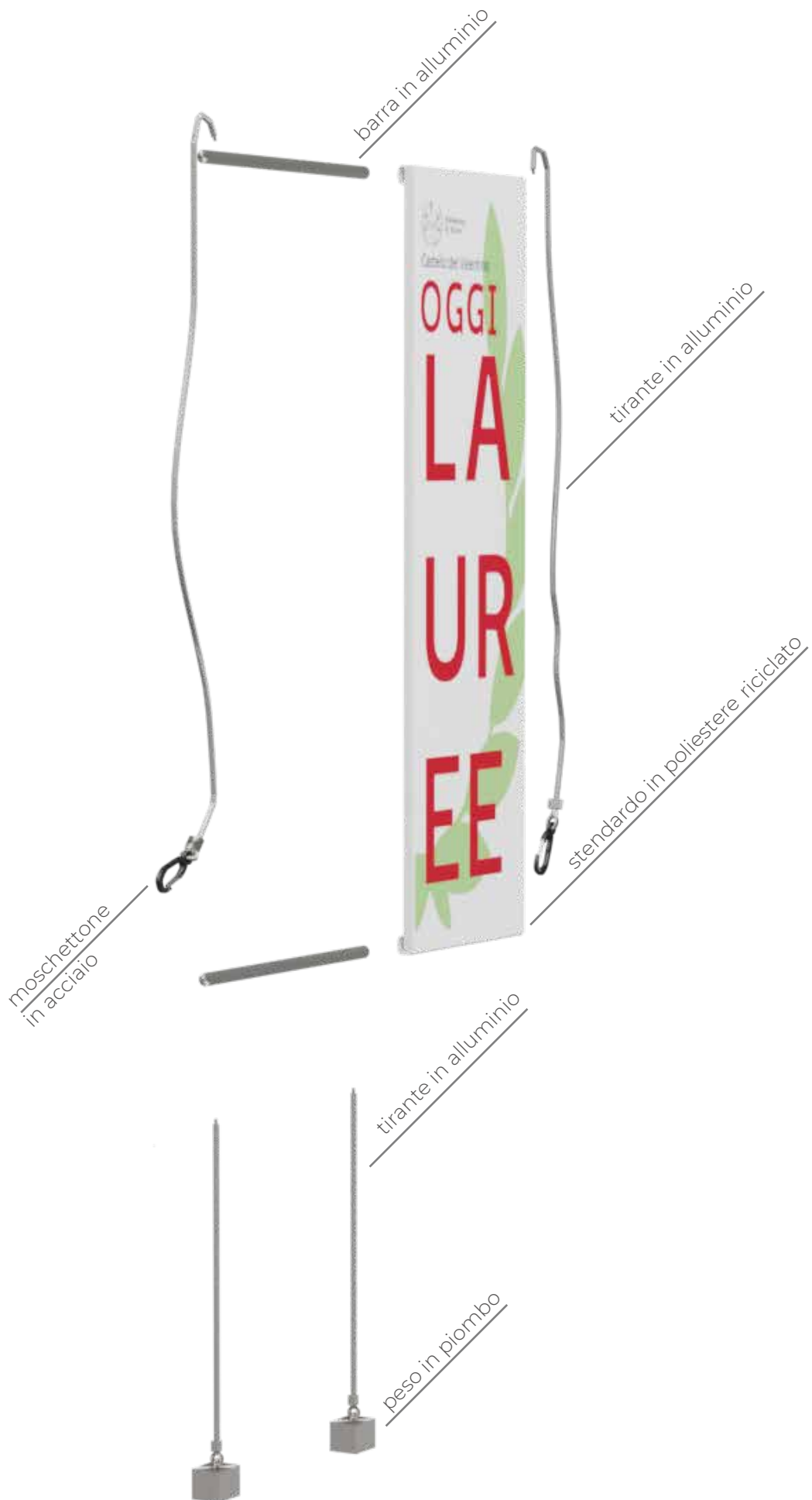
Figura 6.8 _ Render esploso dello stendardo
