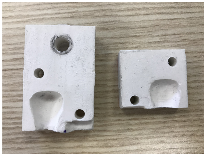
Figura 2.12: Afferraggi in ABS per la prova di flessione; a sinistra la porzione inferiore e a destra la porzione superiore.
