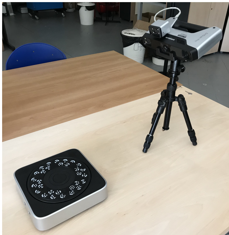
Figura 2.25: Setup necessario per la scansione; scanner 3D EinScan Pro HD posizionato su di un treppiede e base rotante su cui va posizionato il metacarpo.
