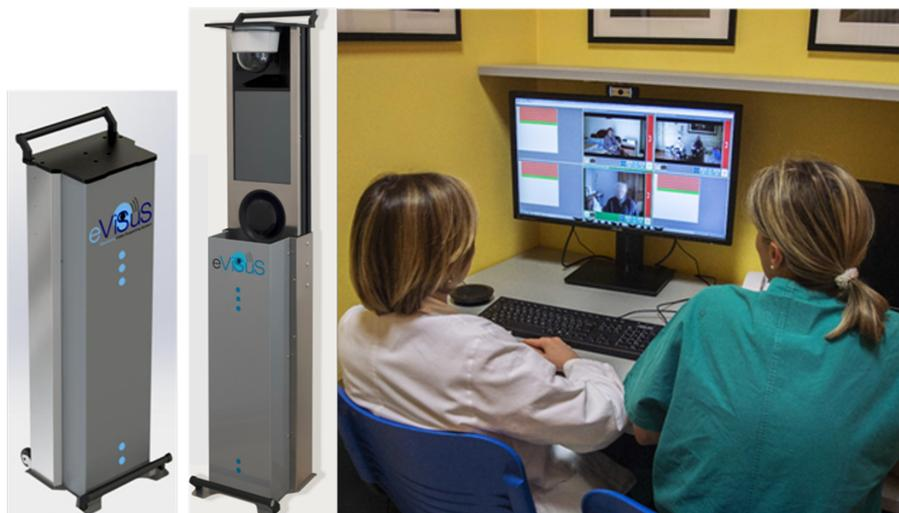
Figura 6.1: Nella parte sinistra viene mostrato il sistema ‘eViSu’ nelle due possibili modalità, la prima modalità di trasporto e quindi retratto e nella seconda con la modalità distesa, configurazione usata durante la Videodialisi. Nella parte destra vengono mostrati due operatori sanitari (una dottoressa e un’infermiera) intesi a sorvegliare più pazienti durante le procedure di dialisi. Fonte: Dottor. Giusto Viglino Direttore Nefrologia e Dialisi ASLCN2.
