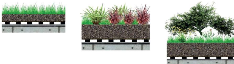
**Immagine 3.8** Da sinistra a destra: sezioni di un tetto verde estensivo, semi-intensivo, intensivo. Si può notare la grande differenza in spessore dei diversi substrati e quantità di vegetazione sulla superficie [38].
