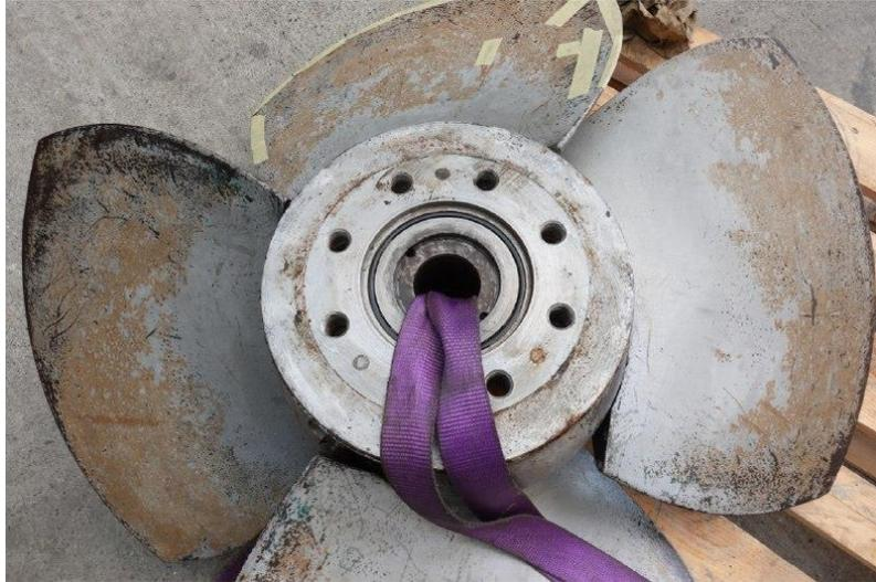
*Figura 17 Pala della girante soggetta a cavitazione*
