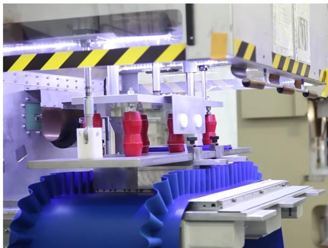
Figura 1.8. Applicazione profili speciali a onde in alta frequenza
