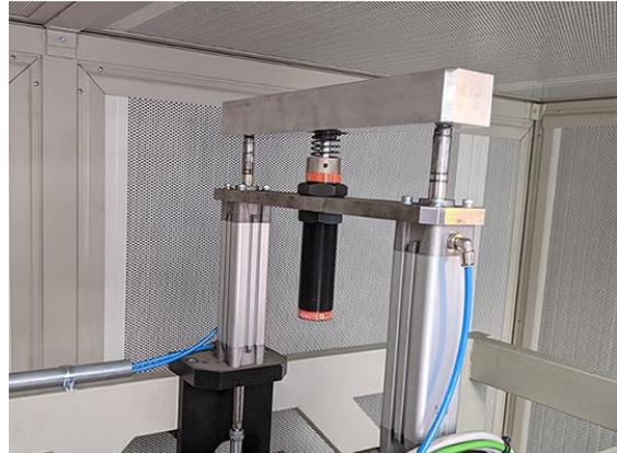
Figura 2.23. Deceleratore idraulico
