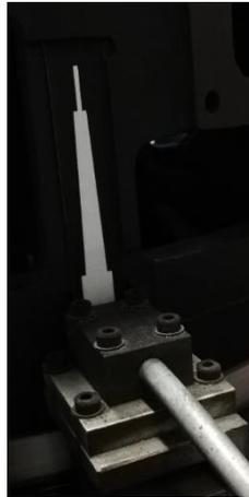
Figura 3.14 - Scala di riferimento per il posizionamento della piattaforma
