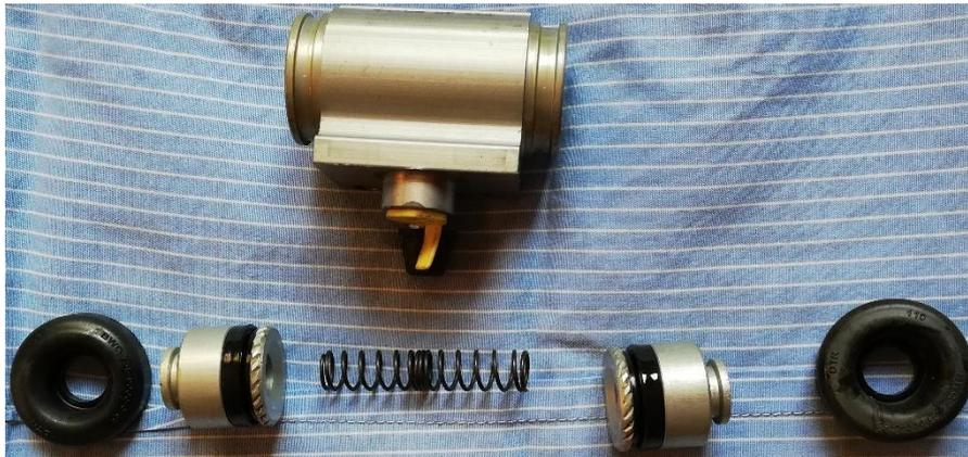
Figura 2.16 - Componenti del cilindretto attuatore
