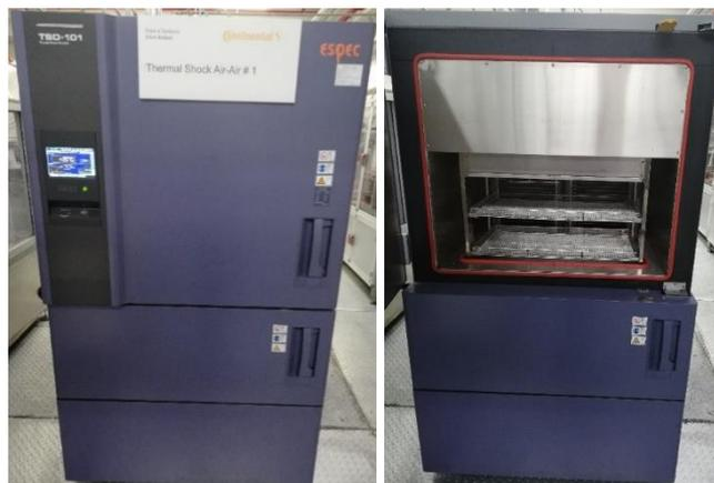
Figura 2.56, 2.57 - Cella climatica per il Thermal Shock
