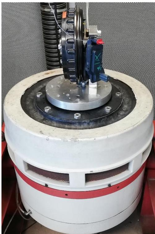
*Figura 3.24 - Installazione completa del freno su shaker*
