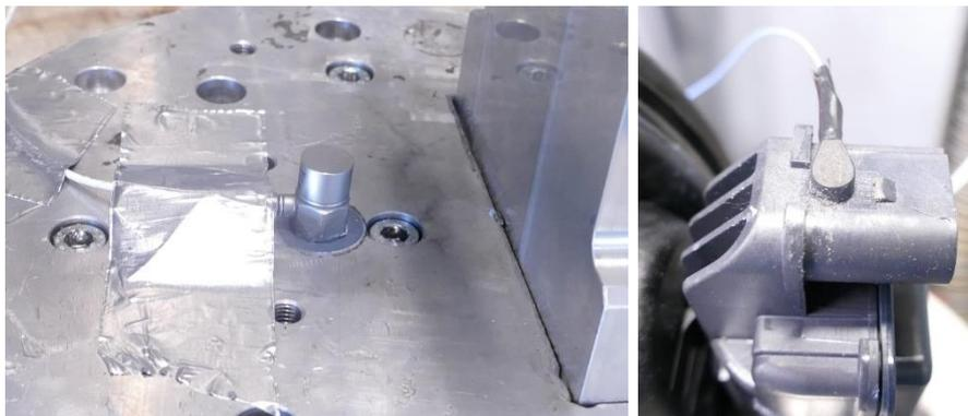
Figura 3.22, 3.23 - Fissaggio degli accelerometri
