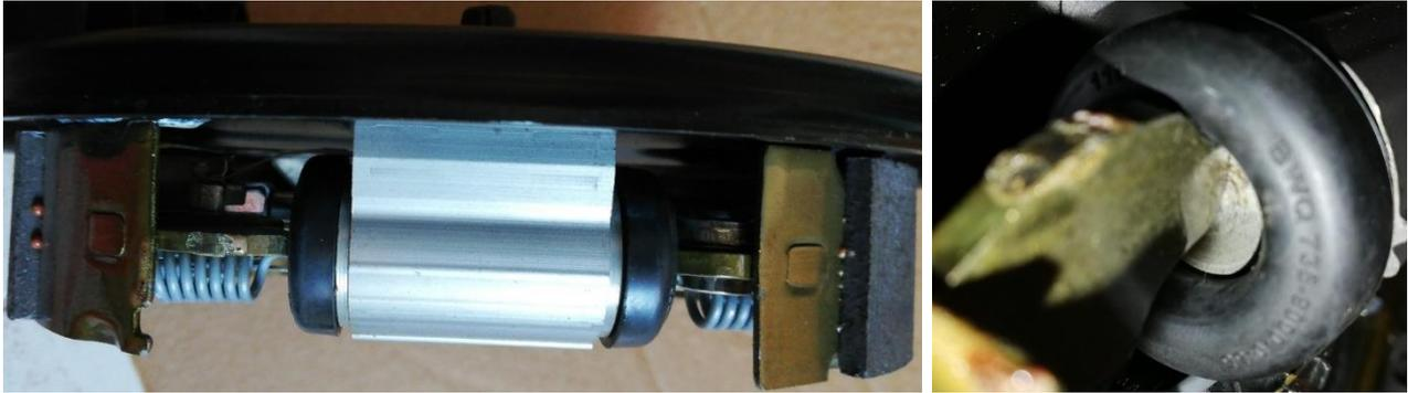
Figura 2.23 - Installazione del cilindretto attuatore e contatto con la ganascia
