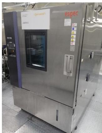
Figura 2.58 - Cella climatica per il Thermal Humidity Cycle
