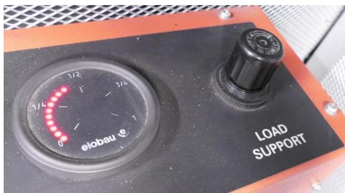
Figura 3.13 - Manopola di regolazione del circuito pneumatico
