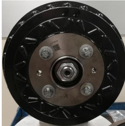
Figura 3.21 - Installazione del mozzo e del tamburo
