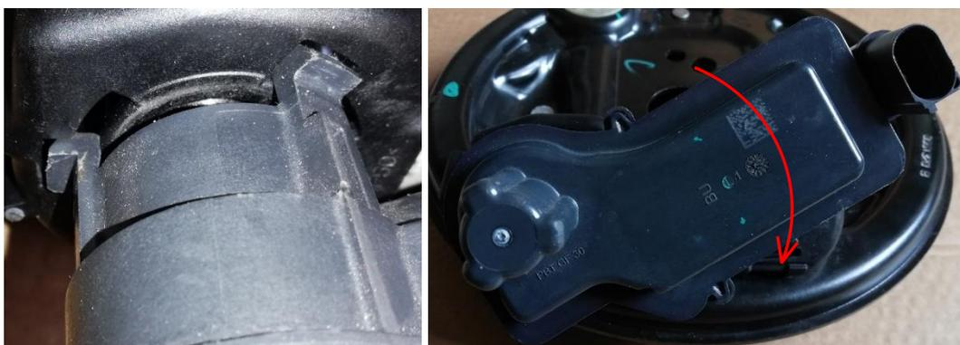
*Figura 2.51, 2.52 - Installazione dell'attuatore sul bracket*
