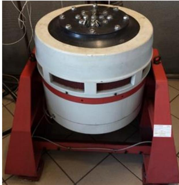
Figura 3.1 - Shaker elettrodinamico
