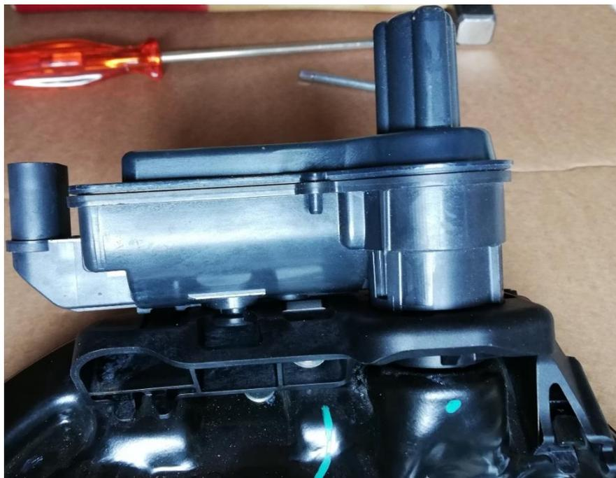
*Figura 2.32 - Sistema EPB SiC-M*
