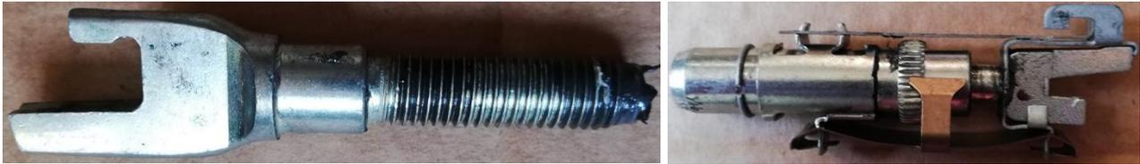
Figura 2.26 - Settore filettato e corpo
