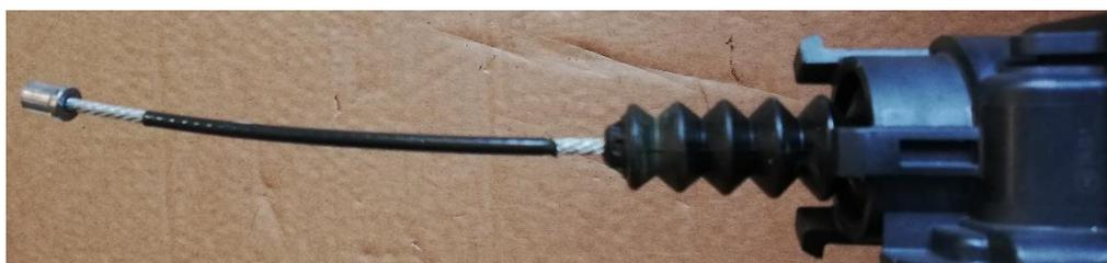
Figura 2.36 - Cavo dell'attuatore
