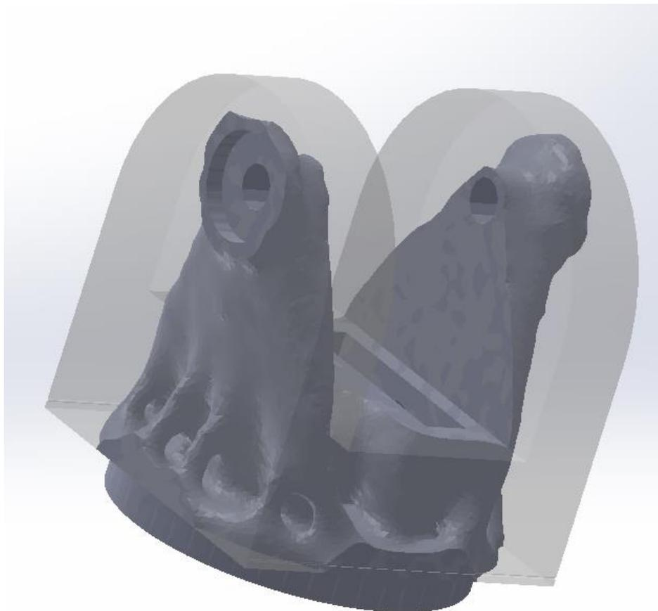
Figura 110 - Ottimizzazione parte 1 del giunto versione 2
